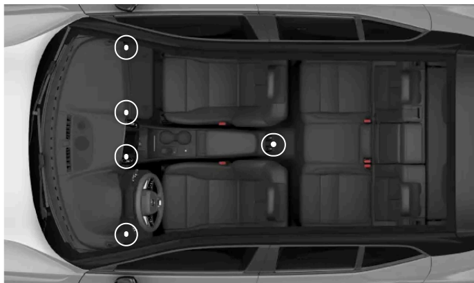
Posizione delle bocchette di ventilazione regolabili
