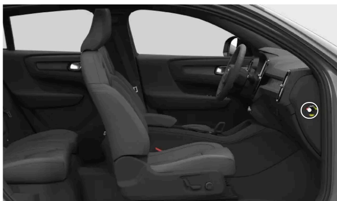
Posizione dell'interruttore dell'airbag passeggero
