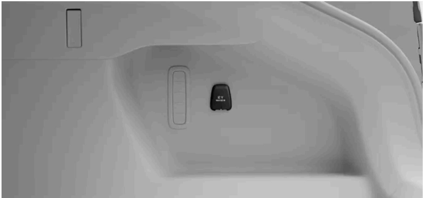
La presa elettrica da 12 V si trova sul lato destro del bagagliaio.
