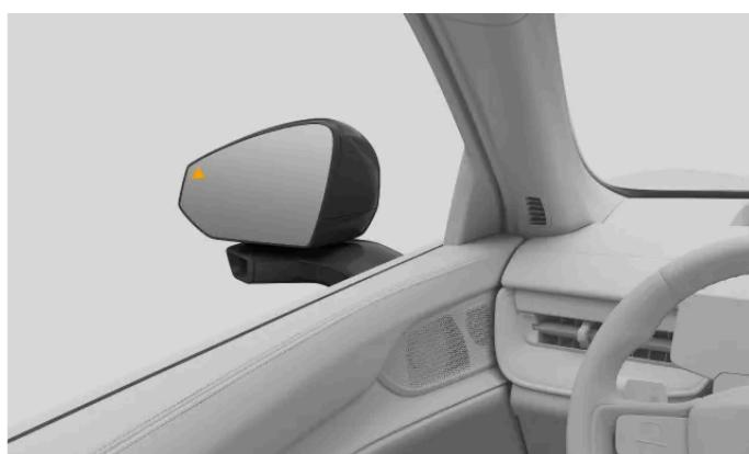
Quando viene rilevato un veicolo nel punto cieco o in avvicinamento, compare una spia nello specchietto laterale.
