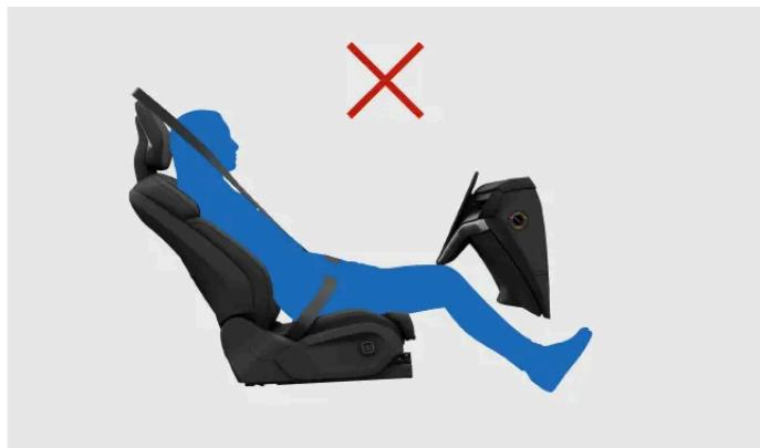
Non inclinare lo schienale per sdraiarti. La cintura di sicurezza deve restare tesa sulla spalla.
