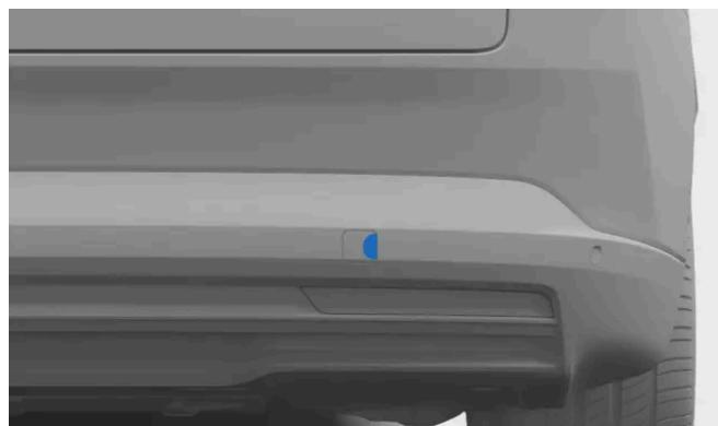
Coperchio di fissaggio dell'occhiello di traino posteriore
