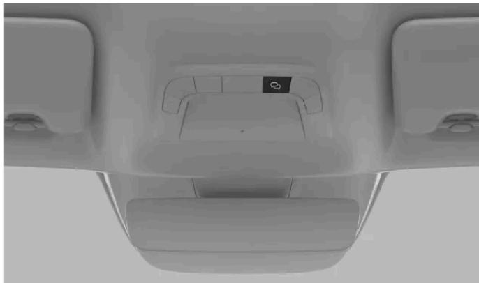
Il pulsante di assistenza si trova nel tetto, sul lato destro della console superiore.
