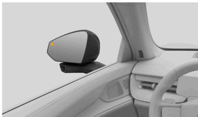
Quando l'auto rileva dei veicoli in arrivo lateralmente, si attiva una luce nello specchietto laterale. Se ti accingi ad aprire la portiera sul lato del veicolo rilevato, l'avviso si intensifica. Insieme agli avvisi visivi può essere emesso un avviso acustico a seconda dell'urgenza.
