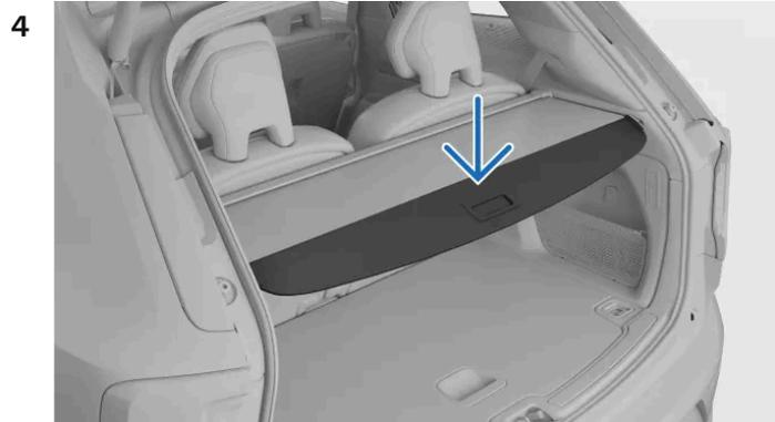
Inclina verso il basso il bordo esterno del pianale in modo che si blocchi in posizione nelle scanalature.
