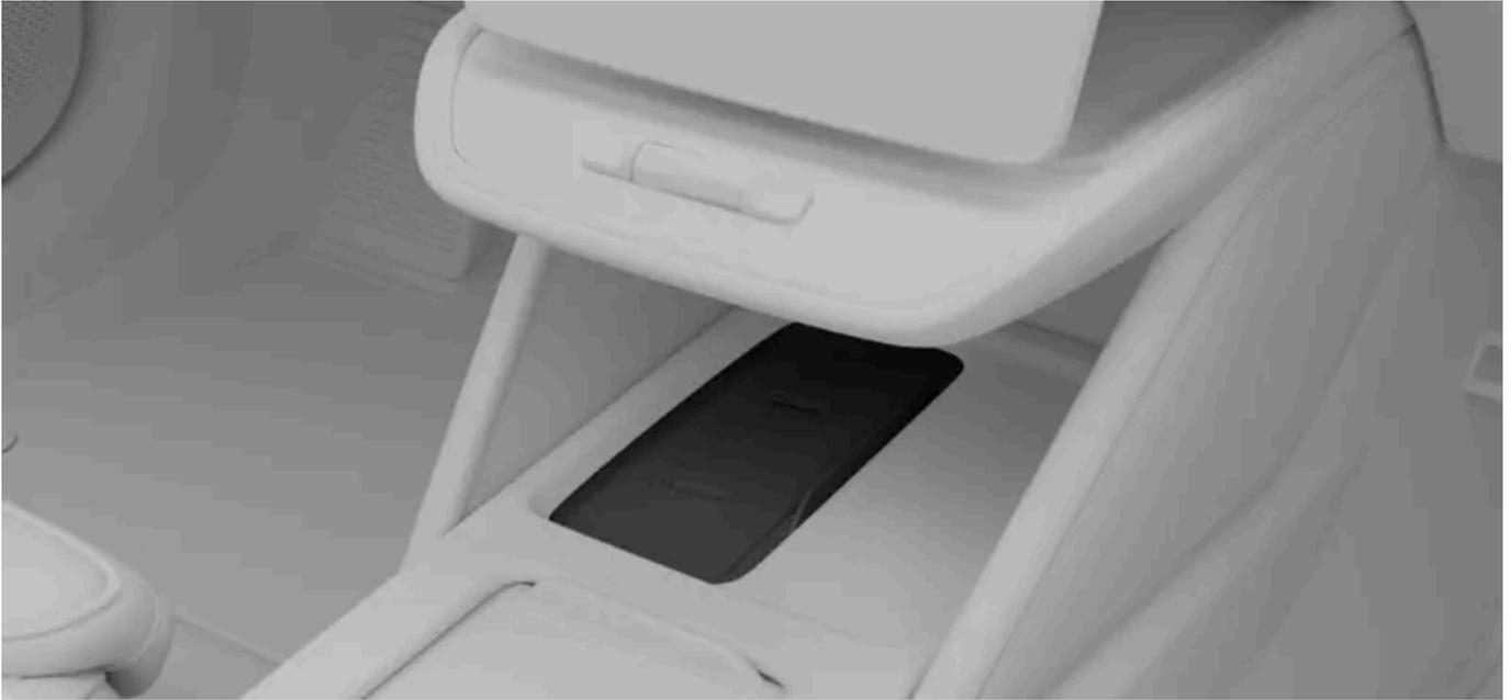
Per utilizzare il caricabatteria wireless, il tuo dispositivo deve essere certificato secondo lo standard di ricarica wireless Qi. Assicurati inoltre che la ricarica wireless sia abilitata sul dispositivo<sup>[1]</sup> e sul caricabatteria stesso. Puoi attivare il caricatore nel display centrale.
