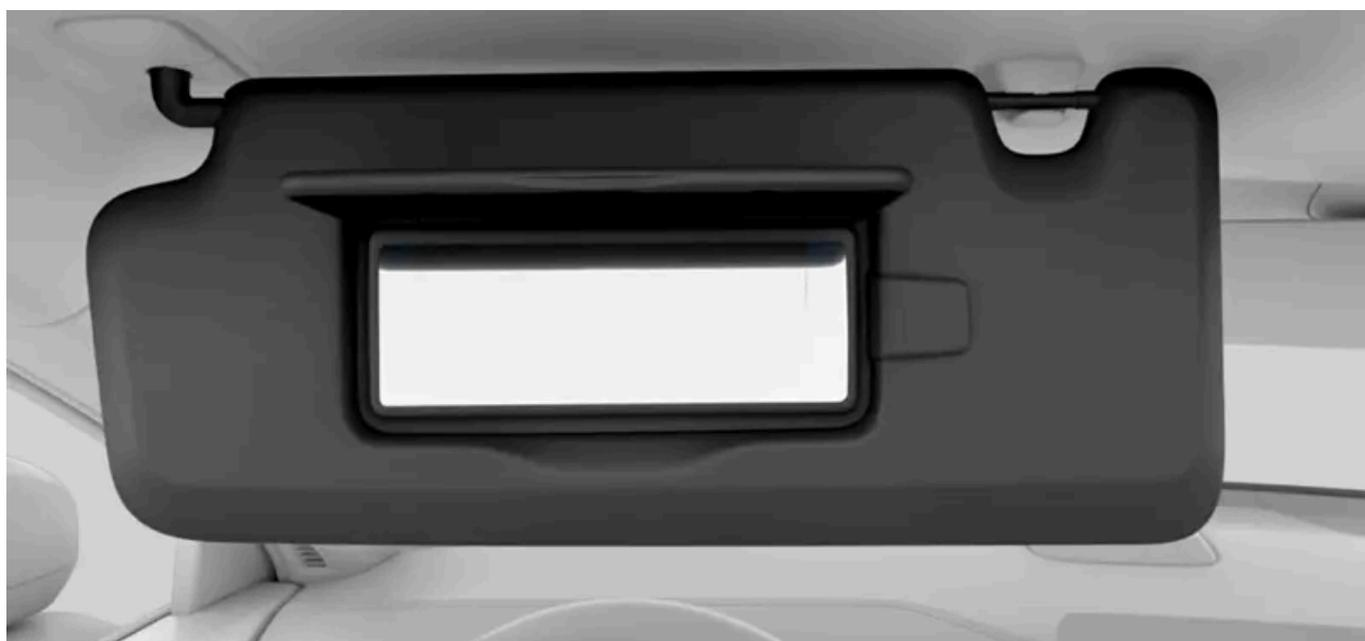
Le alette possono essere ripiegate e inclinate lateralmente all'occorrenza. Con l'aletta parasole inclinata lateralmente, puoi anche allungare l'asta che tiene l'aletta parasole per posizionarla meglio.
