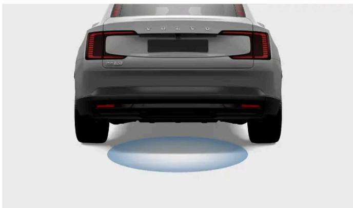
Il sensore rileva il movimento sotto il paraurti posteriore. Qualsiasi movimento rilevato sblocca il bagagliaio.
