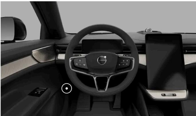
La prima leva si trova sotto il cruscotto sul lato del conducente, proprio davanti alla cerniera della portiera.
