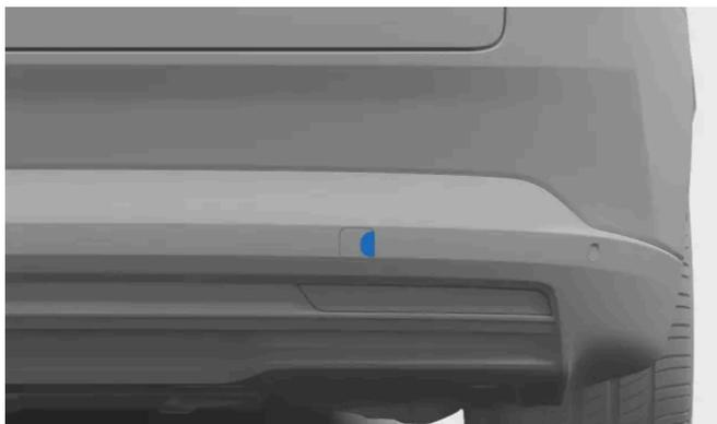
Coperchio di fissaggio dell'occhiello di traino posteriore
