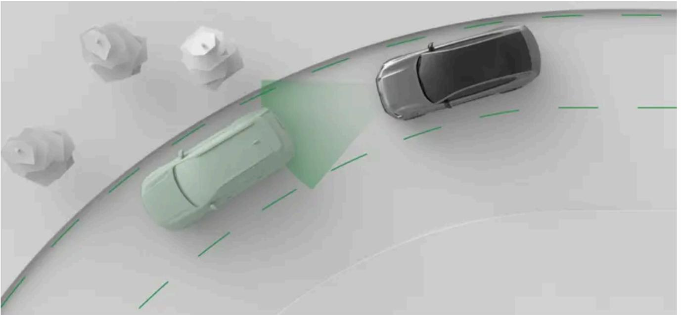
Il Pilot Assist supporta attivamente la tua guida in diversi modi. Quando guidi con il Pilot Assist, puoi selezionare la velocità di riferimento. L'auto gestisce l'accelerazione e la frenata per raggiungere la velocità impostata, adattandosi al traffico circostante.
