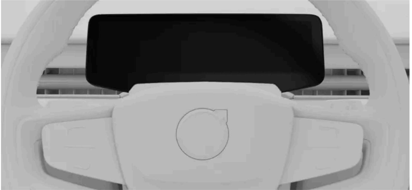
Il display del conducente si trova di fronte al conducente, dietro al volante. La sua posizione cambia insieme a quella del volante quando lo regoli in base alla tua posizione di guida preferita.
