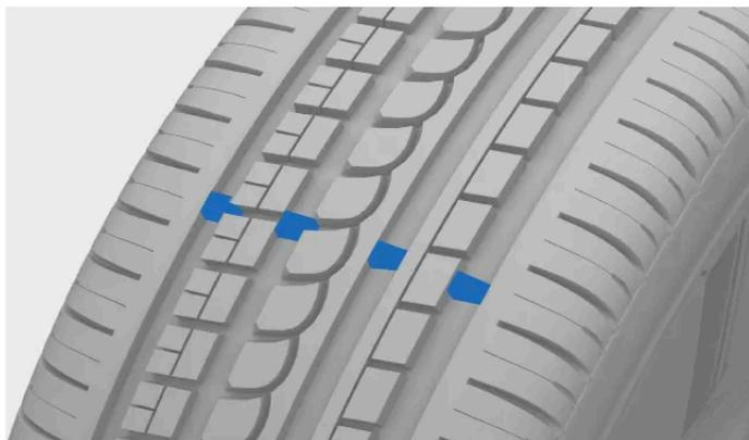
Le scanalature strette che percorrono longitudinalmente il battistrada della gomma sono indicatori di usura. Sul fianco dello pneumatico trovi le lettere TWI <sup>[1]</sup>.
