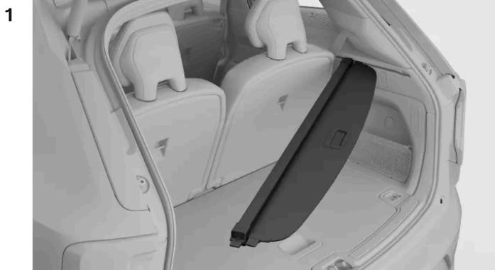
Inserisci un'estremità del pianale nella rientranza della scanalatura su un lato del bagagliaio. La rientranza contrassegnata con una linea di demarcazione. Assicurati che l'estremità del pianale sia allineata alla linea di demarcazione.
