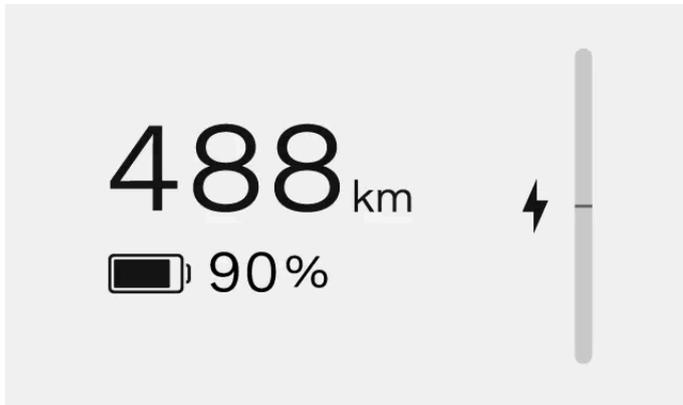
L'autonomia dipende principalmente dal livello della batteria della tua auto e dallo stile di guida, ma anche le condizioni esterne non vanno trascurate. Il livello della batteria e l'autonomia prevista sono visualizzati nel display del conducente. L'autonomia prevista viene calcolata in base al tuo stile di guida, attuale e storico.
