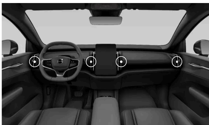
Posizione delle bocchette di ventilazione regolabili.
