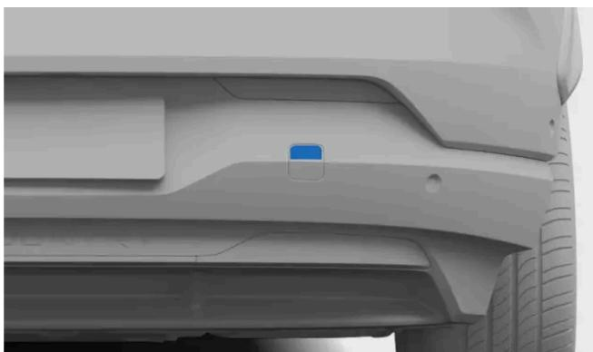
Coperchio di fissaggio dell'occhiello di traino posteriore.
