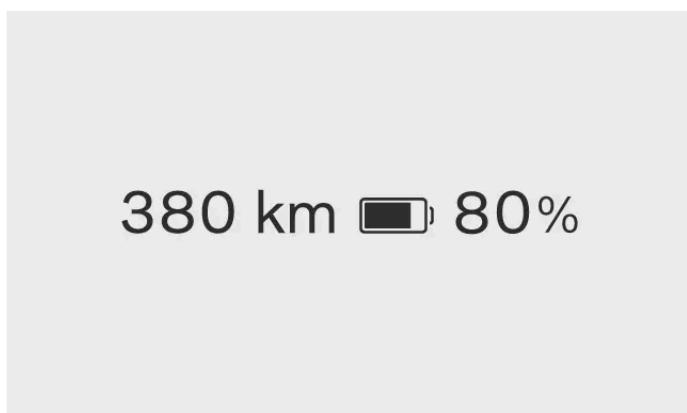
Il misuratore della carica della batteria è sempre presente nel display con le informazioni per il conducente. Il colore dell'icona della batteria cambia a seconda del livello di carica residua della batteria.
