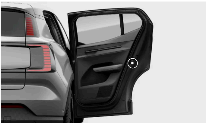
Posizione dell'interruttore della sicura per bambini.
