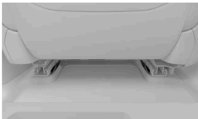
I punti di attacco delle cinghie inferiori dei sedili posteriori si trovano sul retro delle guide a pavimento dei sedili anteriori.
