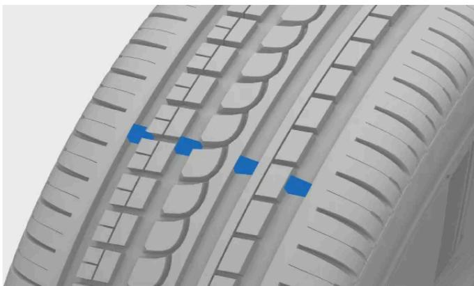
Le scanalature strette che percorrono longitudinalmente il battistrada della gomma sono indicatori di usura. Sul fianco dello pneumatico trovi le lettere TWI [1].
