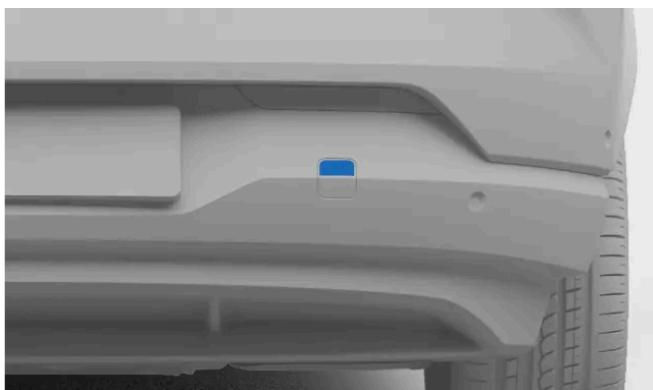
Coperchio di fissaggio dell'occhiello di traino posteriore.
