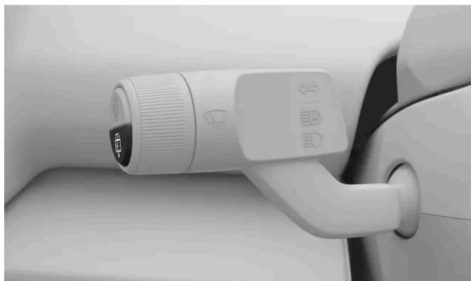
Puoi controllare il tergilunotto del lunotto posteriore utilizzando il pulsante inferiore sulla leva a volante lato sinistro.
