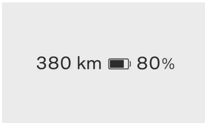
Il misuratore della carica della batteria è sempre presente nel display con le informazioni per il conducente. Il colore del simbolo della batteria cambia a seconda del livello di carica residua della batteria.
