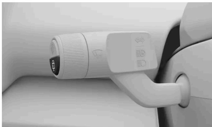
Puoi controllare il tergilavoro del lunotto posteriore utilizzando il pulsante inferiore sulla leva a volante lato sinistro.
