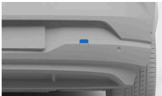
Coperchio di fissaggio dell'occhiello di traino posteriore.
