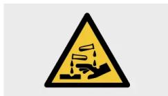
La batteria contiene acido corrosivo.
