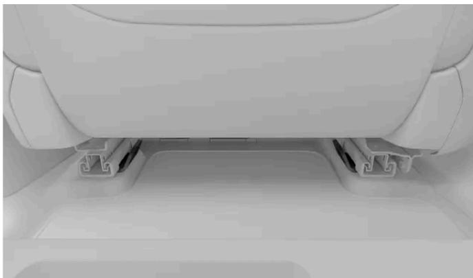
I punti di attacco delle cinghie inferiori dei sedili posteriori si trovano sul retro delle guide a pavimento dei sedili anteriori.
