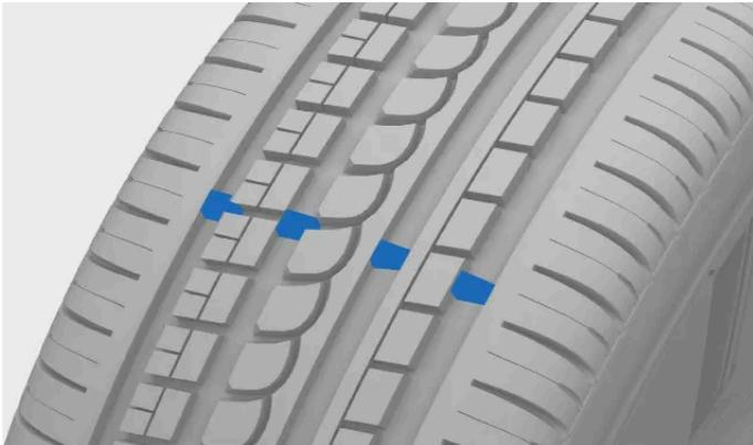
Le scanalature strette che percorrono longitudinalmente il battistrada della gomma sono indicatori di usura. Sul fianco dello pneumatico trovi le lettere TWI <sup>[1]</sup>.
