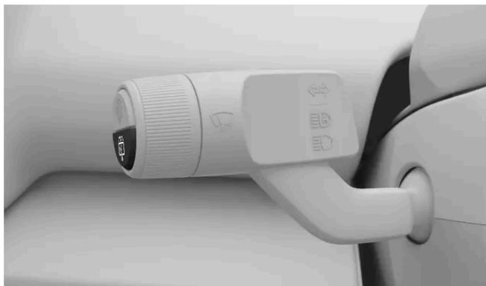
Puoi controllare il tergicristallo del lunotto posteriore utilizzando il pulsante inferiore sulla leva a volante lato sinistro.
