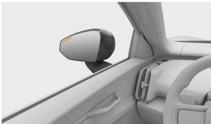
Quando viene rilevato un veicolo nel punto cieco o in avvicinamento, compare una spia nello specchietto laterale.
