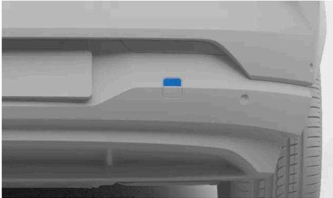
Coperchio di fissaggio dell'occhiello di traino posteriore.
