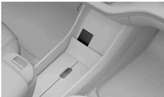
La posizione del lettore di chiavi elettroniche, che serve se si avvia l'auto con una chiave elettronica o una chiave con comando a distanza scarica.
