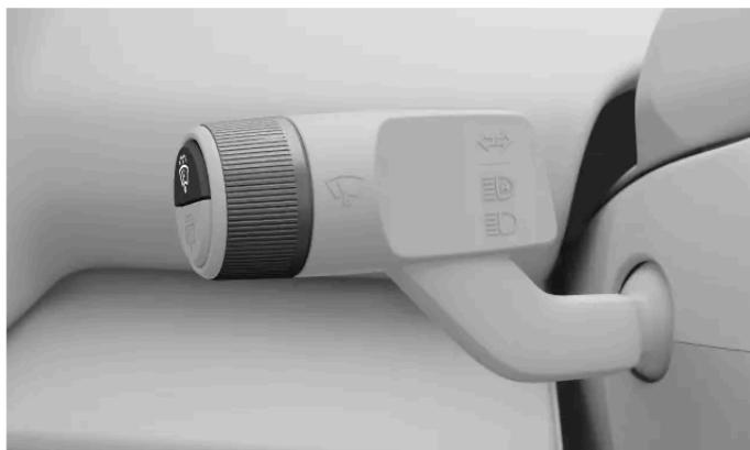
Il tergilavavetro anteriore ha diverse modalità di funzionamento che puoi attivare utilizzando la leva a volante sinistra. Le modalità sono:
