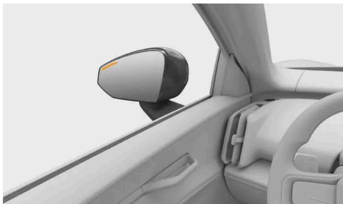
Quando l'auto rileva dei veicoli in arrivo lateralmente, attiva una luce nello specchietto laterale e una notifica sul display. Se ti accingi ad aprire la portiera sul lato del veicolo rilevato, l'avviso si intensifica. Insieme agli avvisi visivi può essere emesso un avviso acustico a seconda dell'urgenza.
