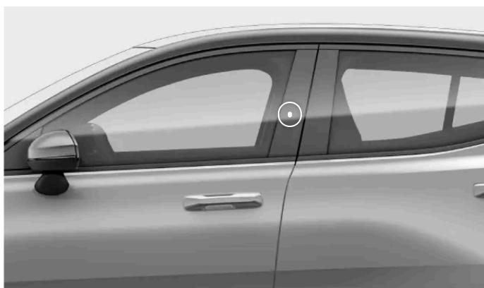
Punto di rilevamento delle chiavi sul montante della portiera del conducente
