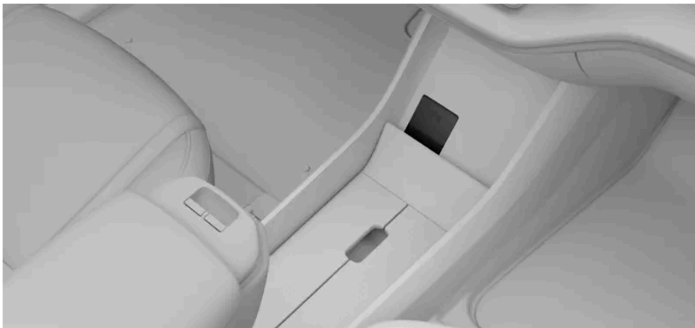
Il caricabatteria wireless sotto il display
