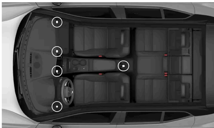
Posizione delle bocchette di ventilazione regolabili
