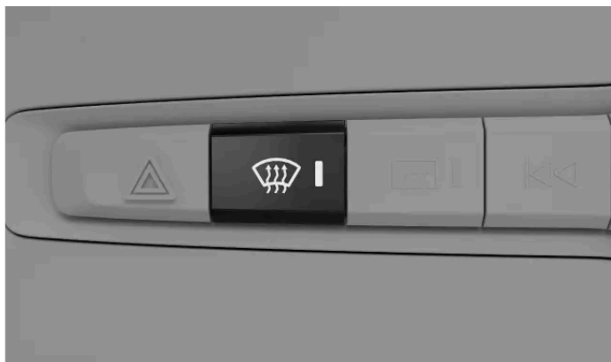
Pulsante dello sbrinatoro massimo sulla plancia di comando sotto il display centrale
