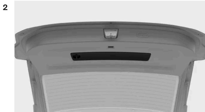
Il triangolo di emergenza si trova all'interno del bagagliaio. Apri il vano ruotando la maniglia in posizione verticale e poi tirala.
