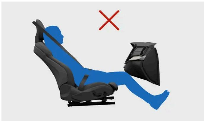
Non inclinare lo schienale per sdraiarti. La cintura di sicurezza deve restare tesa sulla spalla.
