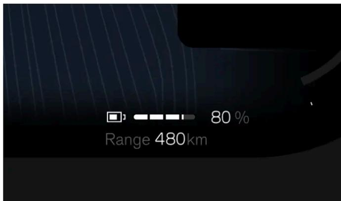
L'autonomia dipende principalmente dal livello della batteria della tua auto e dallo stile di guida, ma anche le condizioni esterne non vanno trascurate. Il livello della batteria e l'autonomia prevista sono visualizzati nel display del conducente. L'autonomia prevista viene calcolata in base al tuo stile di guida, attuale e storico.
