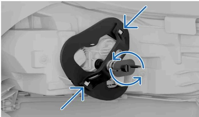
Svita la vite a molla ruotando in senso antiorario. Lascia la vite nel ponticello di supporto in modo da poterla ritrovare quando serve.
