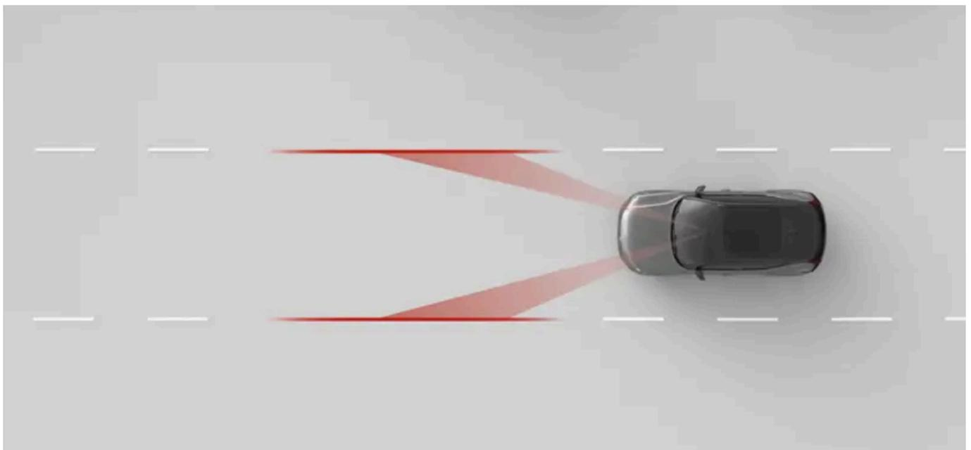
Quando il sistema di mantenimento della corsia è attivo, l'auto può avisarti se stai per uscire dalla tua corsia di marcia e può chiederti di guidare con attenzione. Può anche intervenire sullo sterzo. Il sistema di mantenimento della corsia si basa sulla telecamera anteriore dell'auto per identificare la segnaletica stradale e la tua posizione nella corsia.
