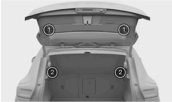
Ci sono due punti di fissaggio sul piano portaoggetti e due sul portellone del bagagliaio. Quando il piano portaoggetti è montato, i cordini sono fissati tra gli appositi punti sul piano portaoggetti e il bagagliaio.
