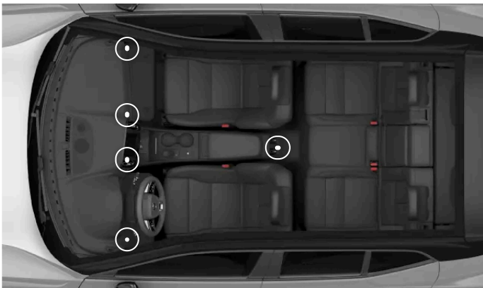
Posizione delle bocchette di ventilazione regolabili
