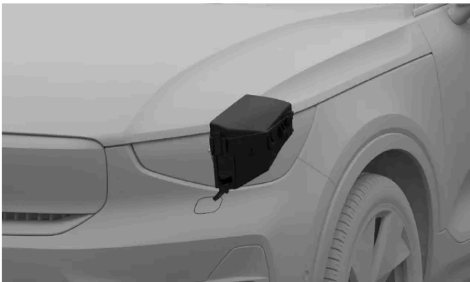
Posizione del portafusibili
