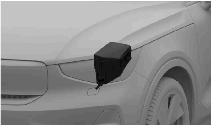
Posizione del portafusibili
