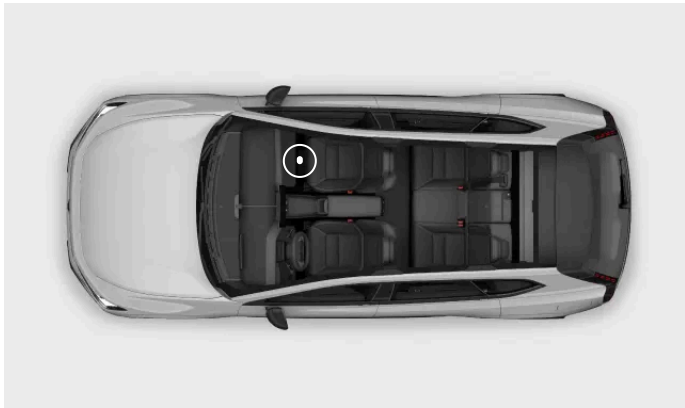
Posizione del VIN sul montante sotto il sedile del passeggero
