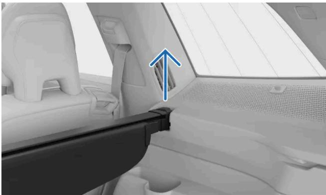
Solleva completamente il pianale dalle rientranze sul retro del bagagliaio per rimuoverlo.
