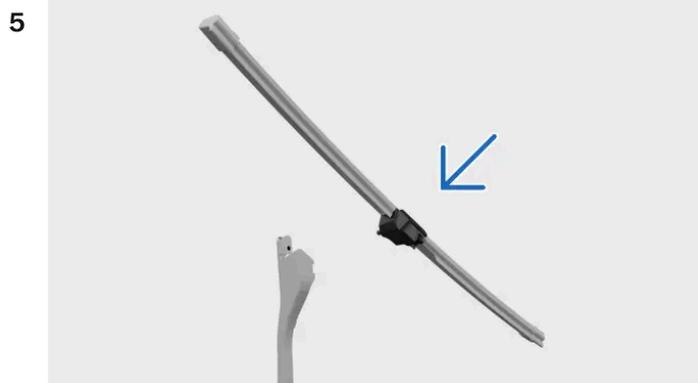
La spazzola del lato conducente deve essere più lunga di quella del lato passeggero. Fai scorrere la spazzola sul braccio del tergicristallo mantenendola orizzontale. Controlla che il perno del braccio del tergicristallo entri nel foro della spazzola.
