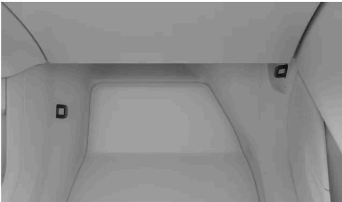
Con la cinghia inferiore accessoria<sup>[1]</sup>, i punti di attacco del sedile del passeggero anteriore si trovano ai lati del vano piedi del sedile.
