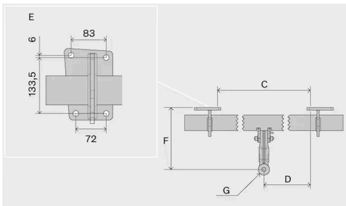
Misure, punti di fissaggio in millimetri (pollici)
