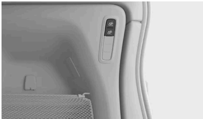
Sul lato destro del bagagliaio trovi una pulsantiera. I due pulsanti in alto, uno per ogni sedile, si possono usare per abbattere e sollevare i sedili della terza fila. Questa posizione può esserti utile se hai bisogno aumentare lo spazio per riporre i bagagli.
