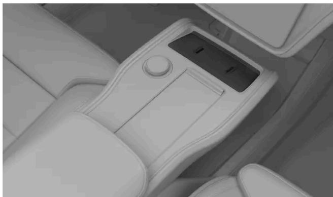
La posizione del lettore di chiavi elettroniche, che serve se si avvia l'auto con una chiave elettronica o una chiave con riconoscimento a distanza scarica.
