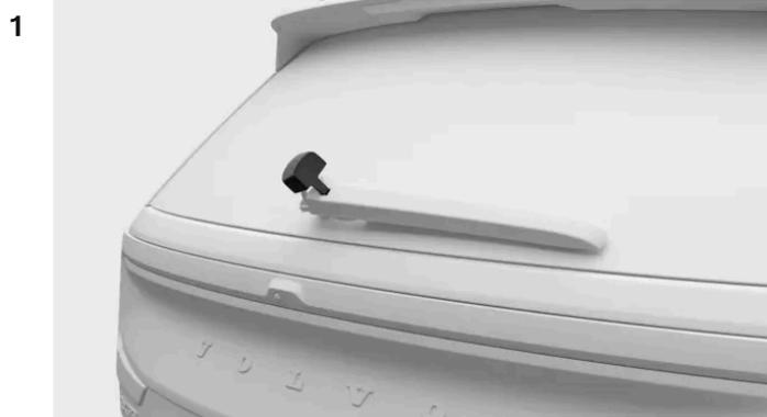
Individua la protezione di plastica nel punto in cui il braccio del tergicristallo è fissato all'auto. Allenta prima il lato della protezione più vicino a te e poi quello più lontano. Solleva completamente la protezione di plastica. In questo modo accedi al connettore del tubo.
