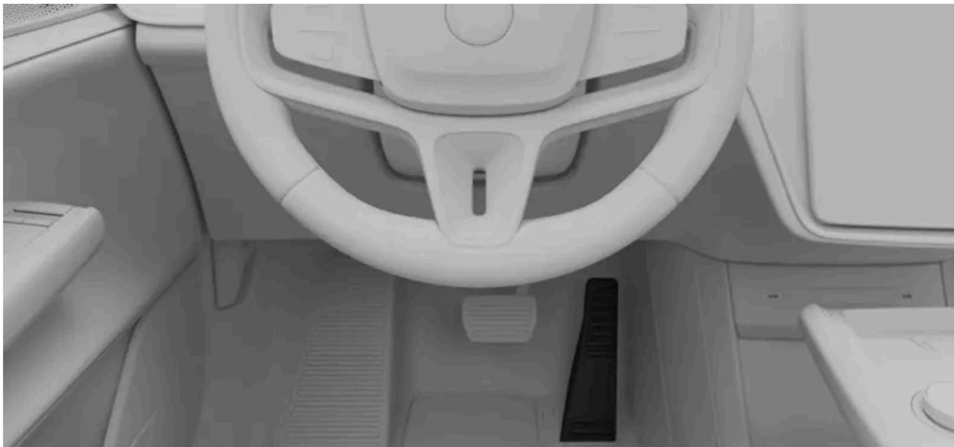
Il comportamento di frenata cambia quando usi il pedale acceleratore. Quando premi l'acceleratore, l'auto accelera normalmente ma se rilasci il pedale si attiva la frenata. Più premi il pedale, più aumenti l'azione frenante. Rilasciando completamente l'acceleratore, la tua auto si fermerà completamente.
