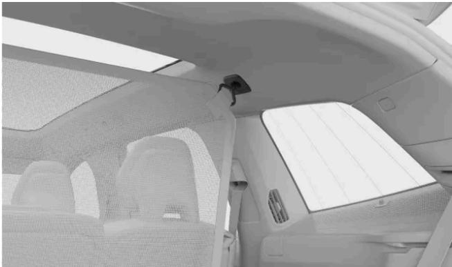
Inserisci tutti i perni della rete di sicurezza nei fori ai lati del tetto interno. Spingi i perni in avanti finché non si bloccano in posizione.
