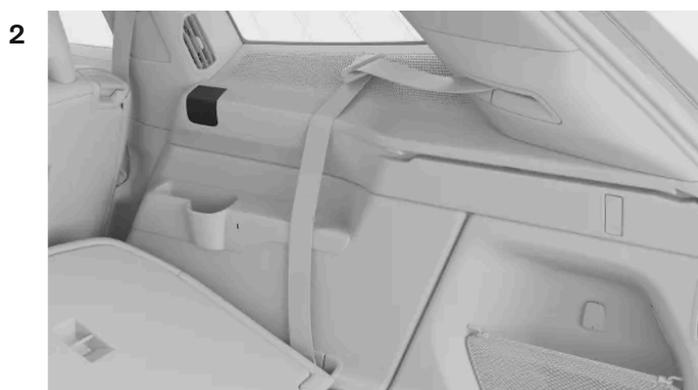
Rimuovi le protezioni delle rientranze sui lati del bagagliaio posteriore.
