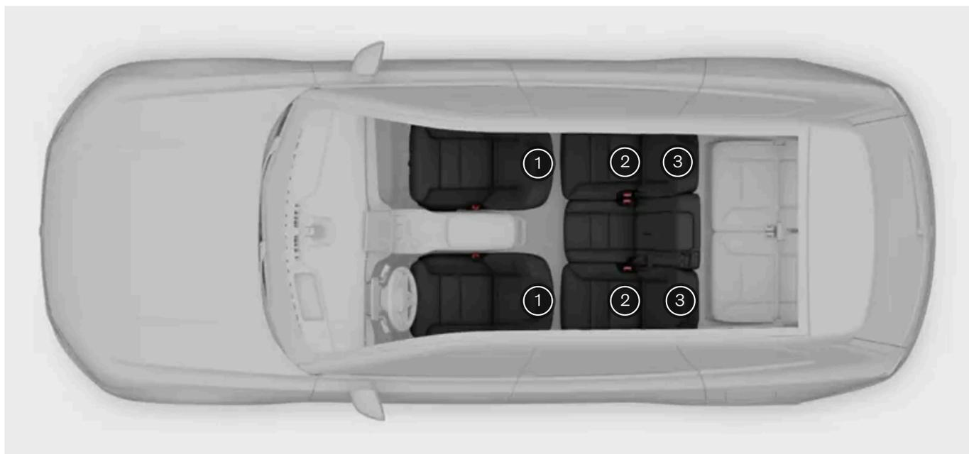
**1** Punti di fissaggio della cinghia inferiori sulle guide a pavimento dei sedili anteriori<sup>[1]</sup>
