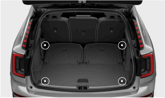
Gli occhielli di fissaggio del carico si trovano ai quattro angoli del bagagliaio. Gli occhielli di fissaggio del carico possono essere utilizzati per fissare le cinghie e assicurare il carico nel bagagliaio.
