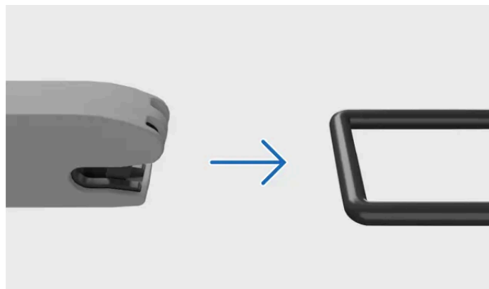
Fissare l'attacco ISOFIX nel punto di fissaggio
