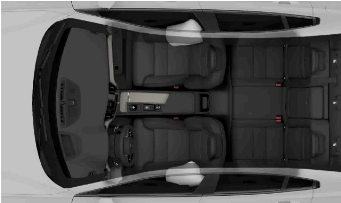
Airbag per collisioni laterali per i passeggeri anteriori.
