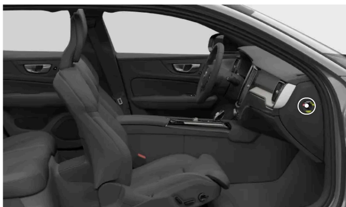
Posizione dell'interruttore dell'airbag passeggero
