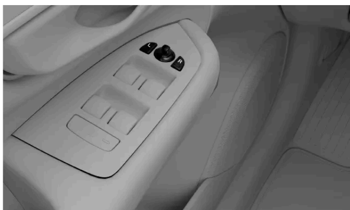
Comandi per la regolazione degli specchietti laterali
