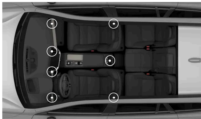
Posizione delle bocchette di ventilazione regolabili
