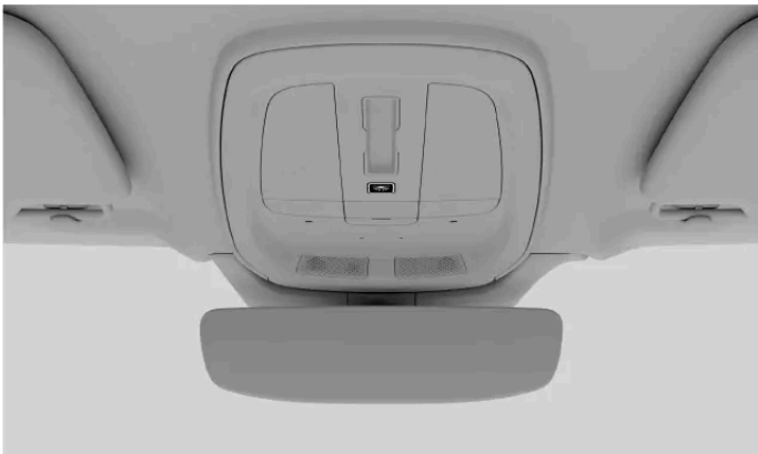
Pulsante di spegnimento automatico delle luci nella console superiore
