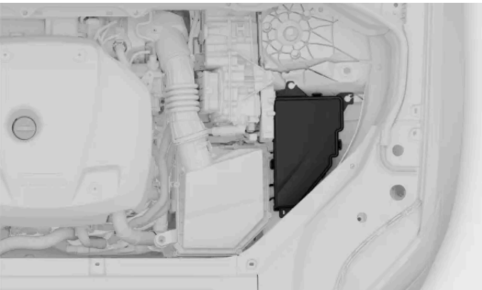
Posizione del portafusibili
