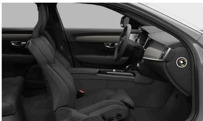
Posizione dell'interruttore dell'airbag passeggero
