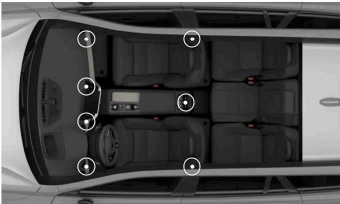
Posizione delle bocchette di ventilazione regolabili
