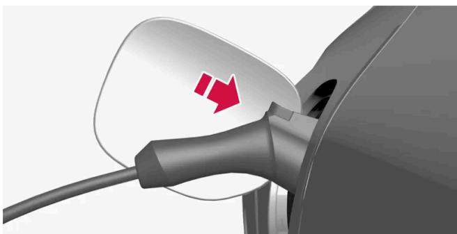
Rimuovere il coperchio protettivo del terminale di ricarica e inserire a fondo il terminale nell'ingresso di ricarica dell'auto.
