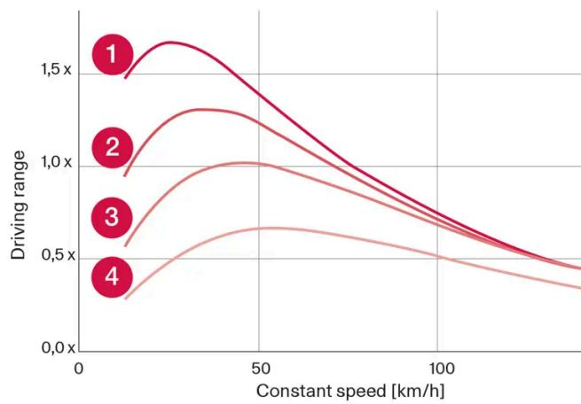
① Temperatura esterna di 20°C (68°F) e climatizzatore spento.
