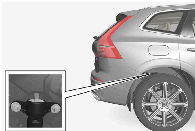
Posizione della manopola di regolazione per le ruote posteriori.
