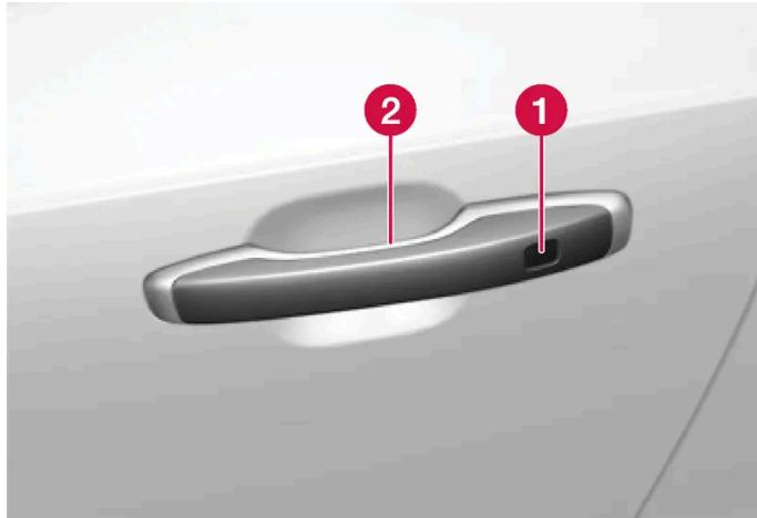
**1** Rientranza sensibile per il bloccaggio
