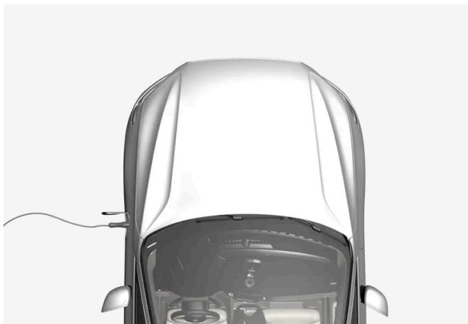
La batteria ibrida viene ricaricata tramite cavo di ricarica ma può ricevere carica durante le frenate leggere e la frenata motore con il cambio in posizione B. La batteria ibrida può essere ricaricata anche con il motore a combustione dell'automobile. La batteria di avviamento dell'auto riceve carica in occasione della ricarica della batteria ibrida.
