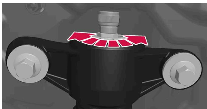
Ruotare la manopola di regolazione in senso orario o antiorario per modificare la posizione di regolazione.
