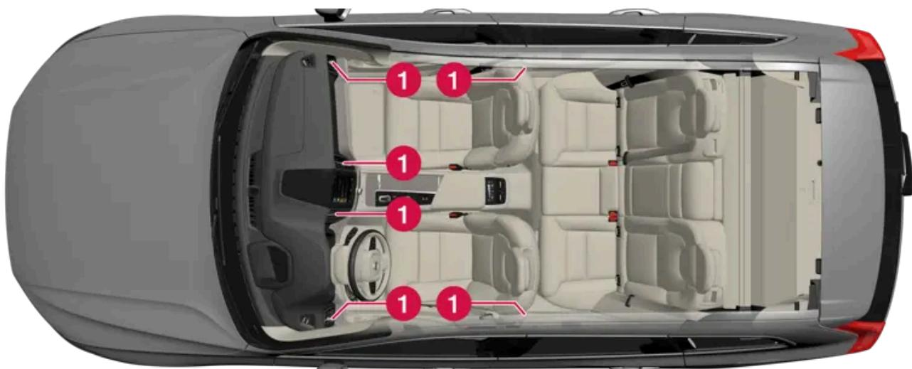
Posizione delle bocchette di ventilazione regolabili nell'abitacolo.
