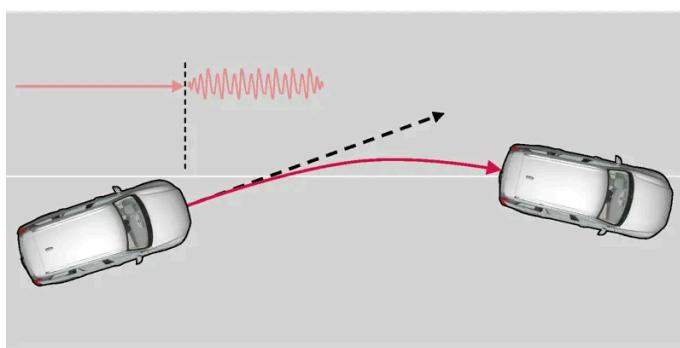
Il mantenimento corsia attivo avverte il conducente mediante vibrazioni del volante.
