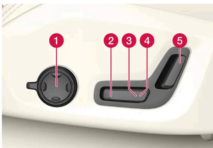
La figura illustra i comandi in un'automobile con supporto lombare a 4 vie\*. Le automobili con supporto lombare a 2 vie\* sono sprovviste di comando multifunzione girevole.
