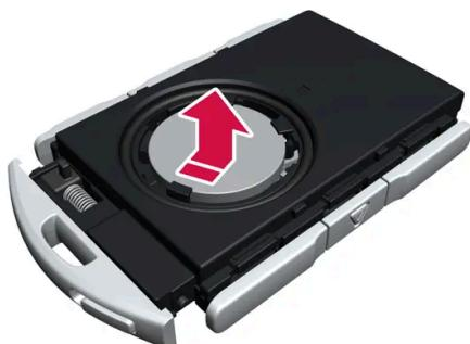
Il lato della batteria (+) è rivolto in su. Rimuovere la batteria premendo sul bordo e quindi sollevandola.
