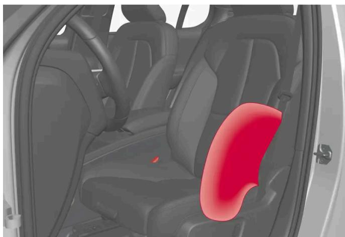
Gli airbag laterali esterni sono montati sui lati esterni degli schienali dei sedili anteriori ed assistono a proteggere il conducente ed il passeggero del sedile anteriore.
