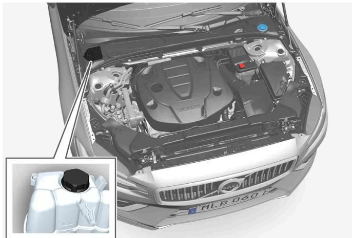
Serbatoio di espansione dell'impianto di raffreddamento
