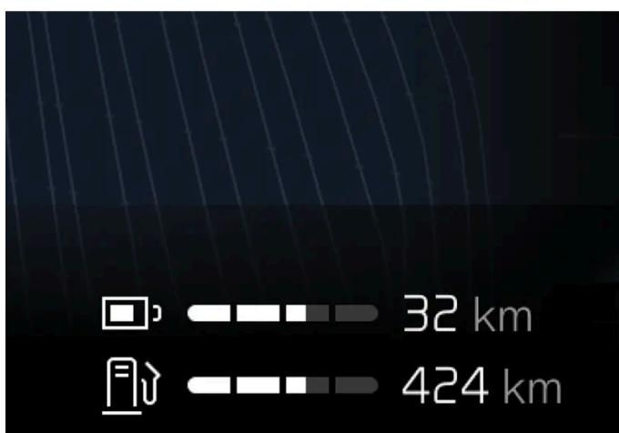
L'autonomia stimata viene visualizzata sul display del conducente.
