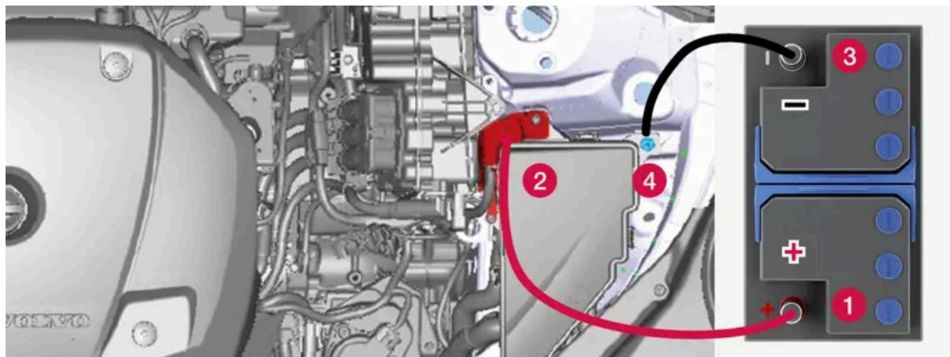
Punti di ricarica per l'avviamento ausiliario della propria automobile. L'aspetto del vano motore può variare a seconda di modello di automobile e livello di equipaggiamento.
