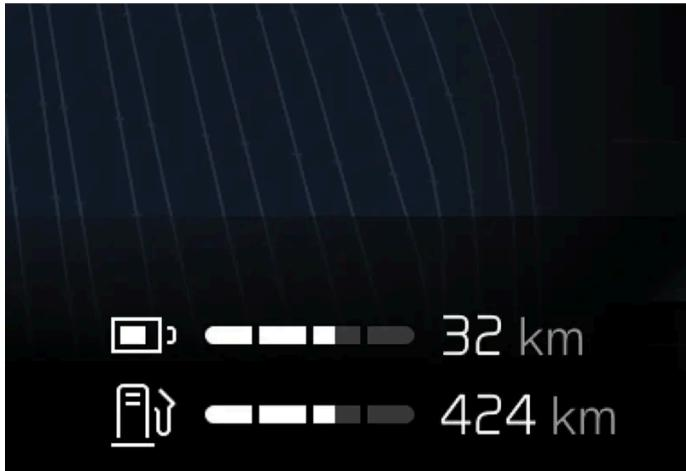
L'autonomia stimata viene visualizzata sul display del conducente.
