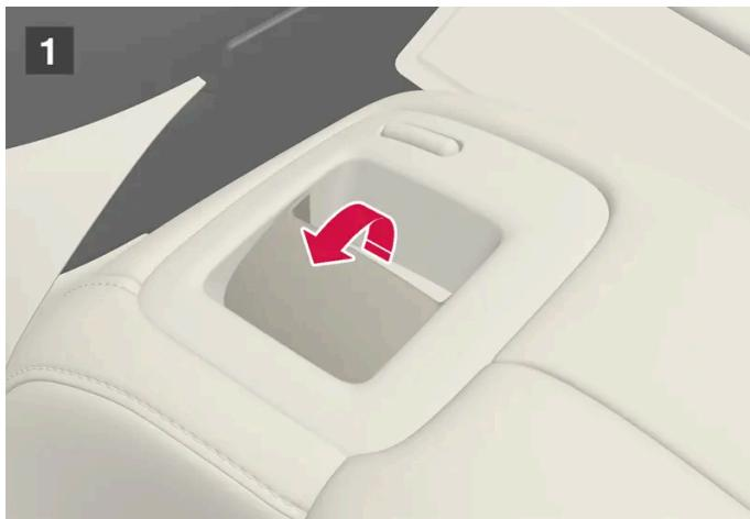
Nelle automobili con ripiegamento elettronico\* dei poggiatesta è possibile ripiegare i poggiatesta esterni con le maniglie sul lato superiore del sedile, vedere l'illustrazione 1. Notare che con questo metodo vengono ripiegati anche gli schienali. Se devono essere ripiegati solo i poggiatesta, per esempio per migliorare la visibilità, procedere invece mediante il display centrale\*.
