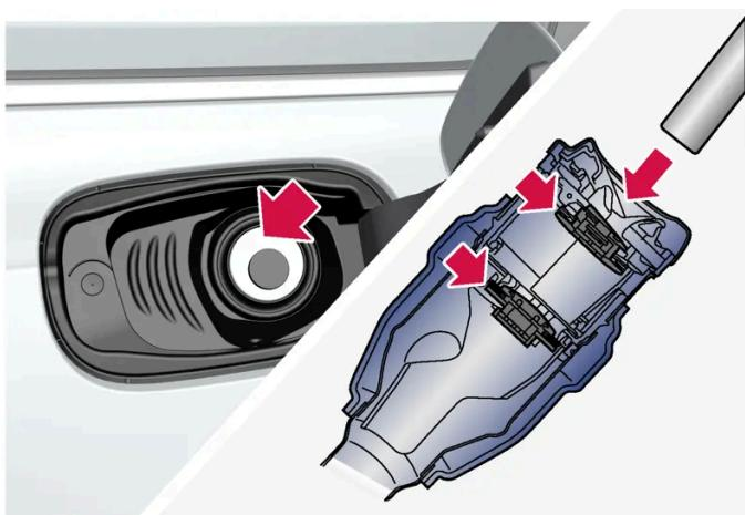
Prima di iniziare il rifornimento, è importante inserire l'ugello della pompa in entrambi gli sportelli apribili del tubo di rifornimento.
