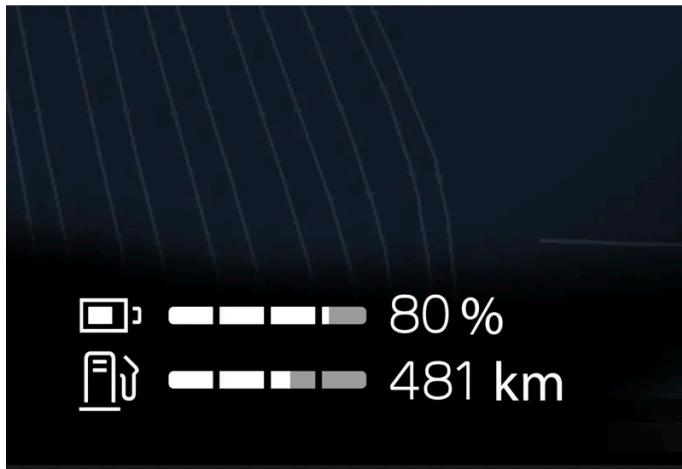
L'indicatore della batteria nella parte bassa del display visualizza il grado di ricarica della batteria nonché l'autonomia fino a esaurimento della batteria.
