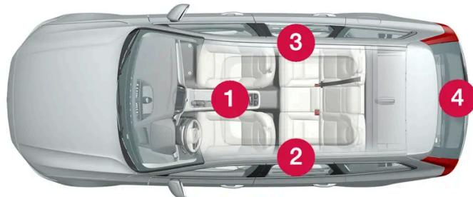
Posizione delle antenne:
