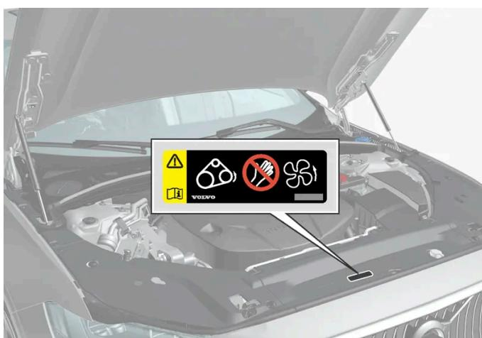
Posizione dell'etichetta di avvertimento per il vano motore. Il vano motore può differire in base al modello e al tipo di motore.
