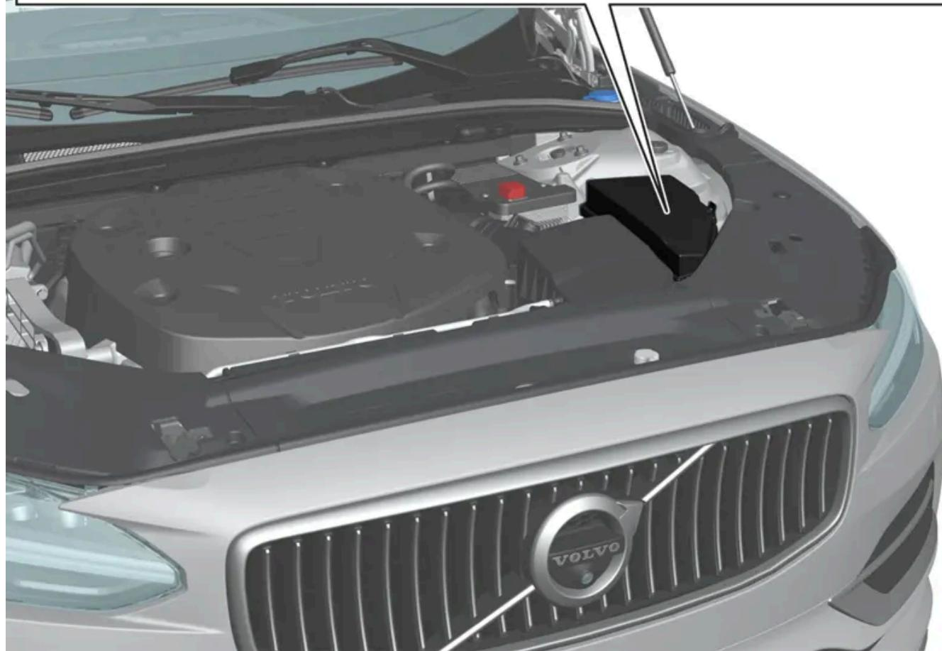
Sul lato interno del coperchio ci sono delle speciali pinze che agevolano la sostituzione dei fusibili scattati.
