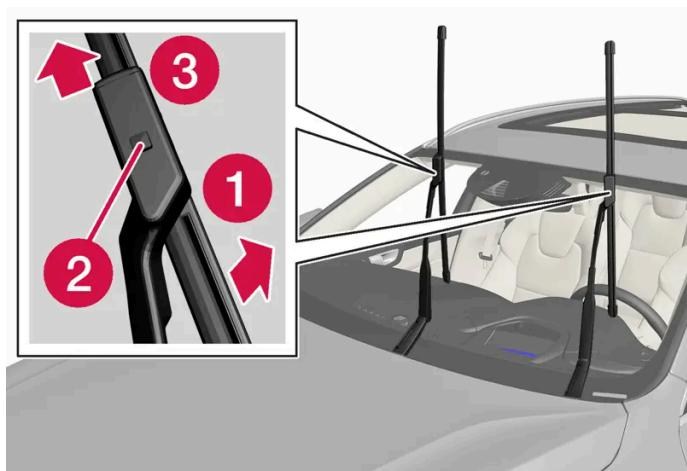
Impostare i tergilicristalli in posizione di assistenza e sollevare i bracci dei tergilicristalli. La posizione di assistenza si attiva/disattiva dal display centrale ad automobile ferma con i tergilicristalli non attivati.
