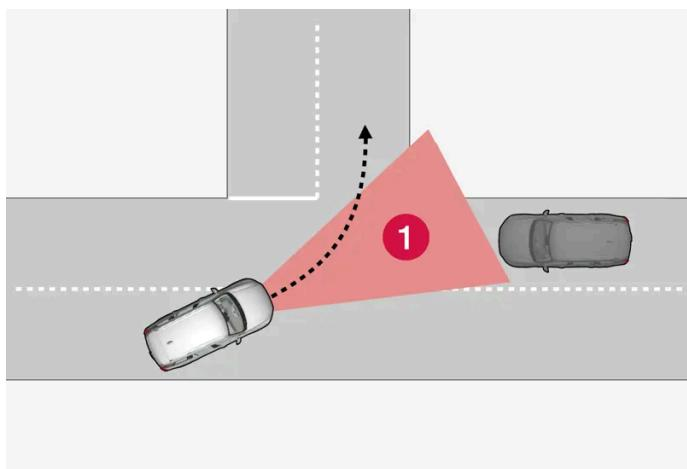
① Settore in cui la funzione è in grado di rilevare un veicolo che procede in direzione trasversale opposta.
