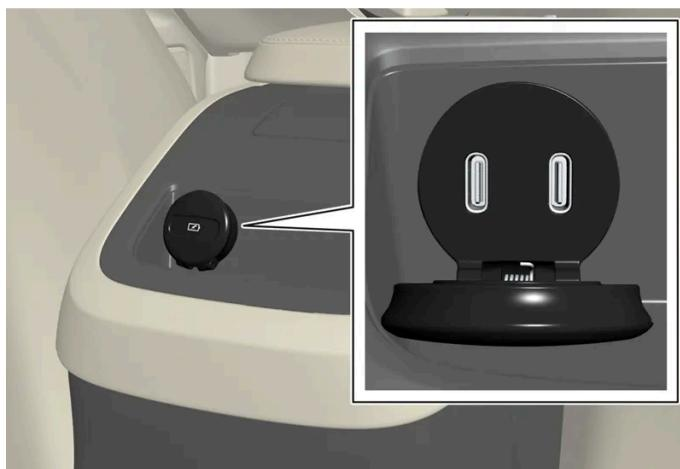
Porte USB (tipo C) nel tunnel, sedile posteriore.
