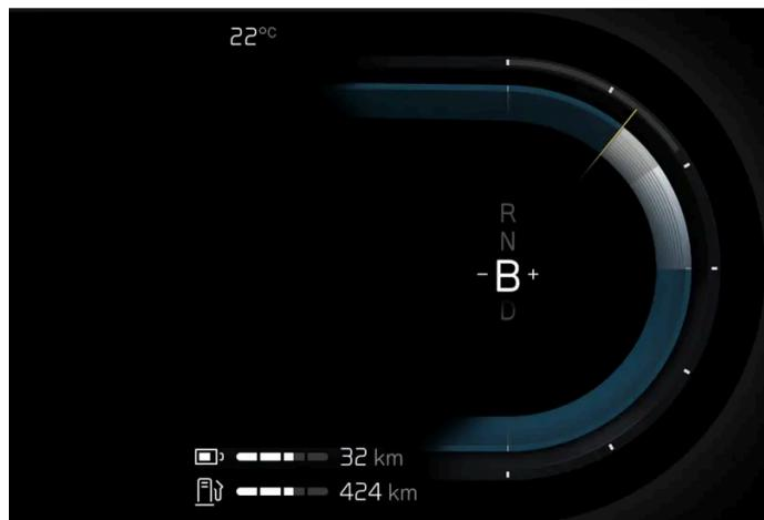
Panoramica della posizione freno sul display del conducente.
