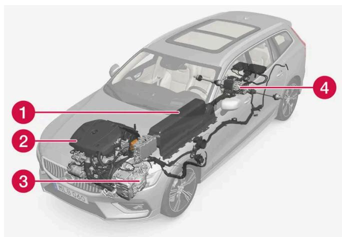
**1** Batteria ibrida - La funzione della batteria ibrida è di accumulare energia. Riceve energia tramite ricarica dalla rete elettrica, frenata rigenerativa o alternatore ad alta tensione. Fornisce energia per l'alimentazione elettrica nonché per azionare temporaneamente il climatizzatore elettrico per il precondizionamento dell'abitacolo.
