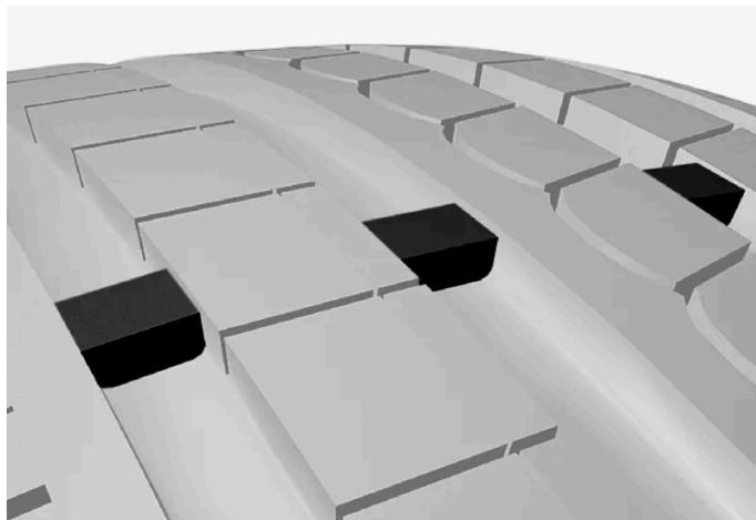
L'indicatore di usura è rappresentato da piccole bande traversali rialzate sui solchi longitudinali del pneumatico. La sigla TWI (Tread Wear Indicator) è stampata sul lato del pneumatico. Quando il pneumatico è consumato a tal punto che rimangono solo 1,6 mm (1/16") di battistrada, queste bande sono chiaramente visibili. In tal caso, sostituire i pneumatici al più presto. Ricordare che un pneumatico con un battistrada così sottile ha un'aderenza molto scarsa in caso di pioggia o neve.
