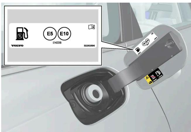
Utilizzare un carburante approvato per l'automobile, vedere l'identificatore <sup>[1]</sup> all'interno dello sportello del serbatoio. Per informazioni sui carburanti approvati e sull'identificatore, vedere la sezione "Benzina".
