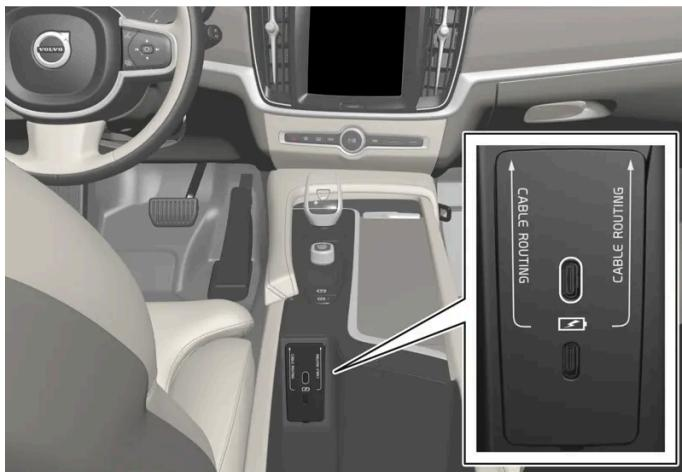
Porte USB per il caricamento delle unità.
