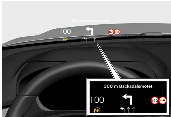
L'Head-Up Display visualizza informazioni selezionate alle quali il conducente dovrebbe reagire al più presto. Ad esempio, avvisi sul traffico, informazioni su velocità e navigazione. Sull'Head-Up Display sono visualizzate anche informazioni relative alla segnaletica stradale e le telefonate in arrivo. L'Head-Up Display è gestito con la pulsantiera al volante di destra e dal display centrale.
