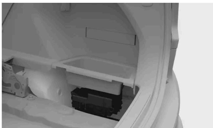
Posizione del portafusibili
