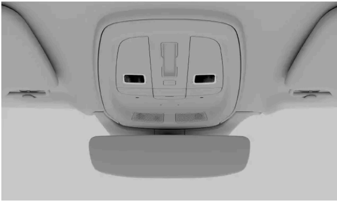
Luci di lettura anteriori nella console superiore
