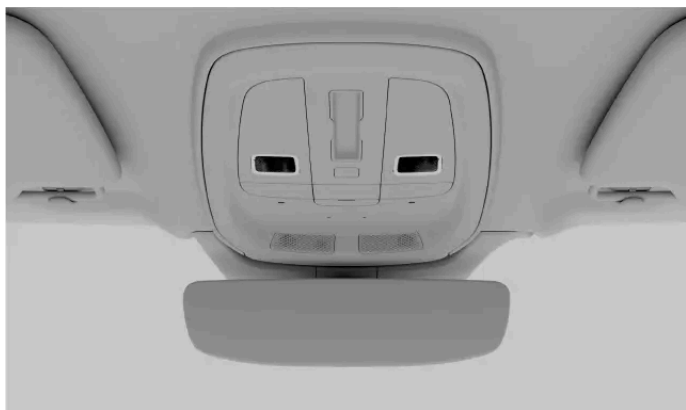
Luci di lettura anteriori nella console superiore
