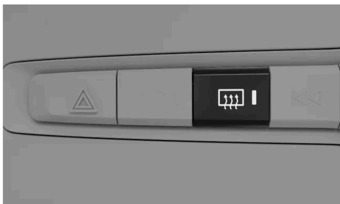
Pulsante del lunotto termico sulla plancia di comando sotto il display centrale
