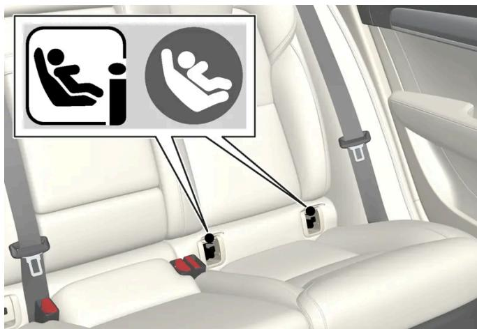
La posizione dei punti di fissaggio per il sedile posteriore è indicata da simboli<sup>[1]</sup> sui coperchi che nascondono i punti di fissaggio.
