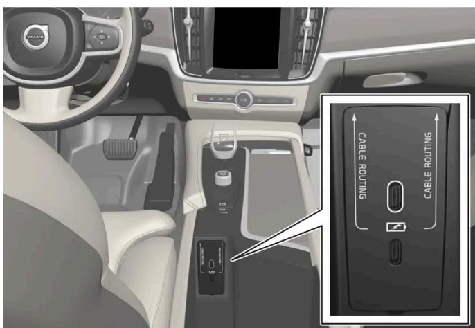
Porte USB per il caricamento delle unità.
