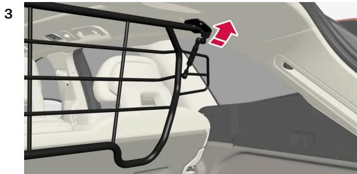
Sistemare i dispositivi di fissaggio della griglia protettiva negli attacchi del padiglione.
