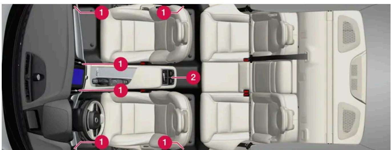
Posizione delle bocchette di ventilazione regolabili nell'abitacolo.
