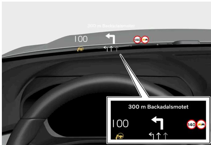
L'Head-Up Display visualizza informazioni selezionate alle quali il conducente dovrebbe reagire al più presto. Ad esempio, avvisi sul traffico, informazioni su velocità e navigazione. Sull'Head-Up Display sono visualizzate anche informazioni relative alla segnaletica stradale e le telefonate in arrivo. L'Head-Up Display è gestito con la pulsantiera al volante di destra e dal display centrale.
