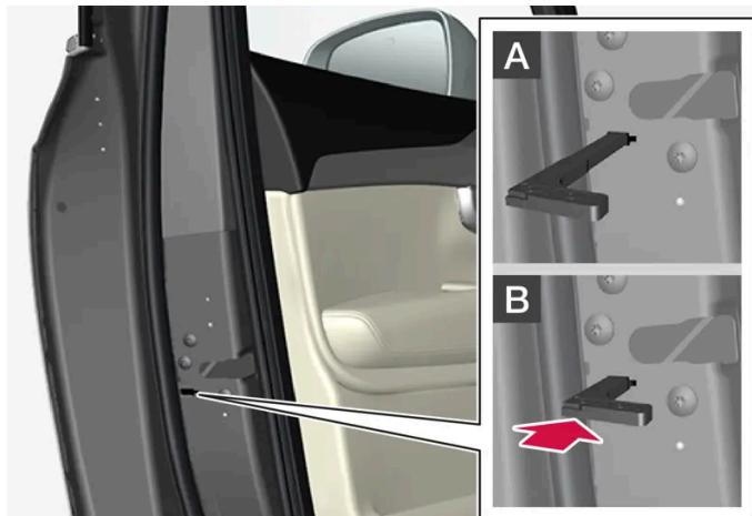
Bloccaggio manuale della portiera. Da non confondere con le serrature per bambini.
