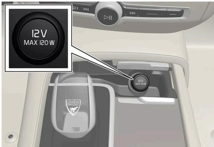
Presa elettrica anteriore nel tunnel per le automobili con caricabatteria wireless per telefono\*.
