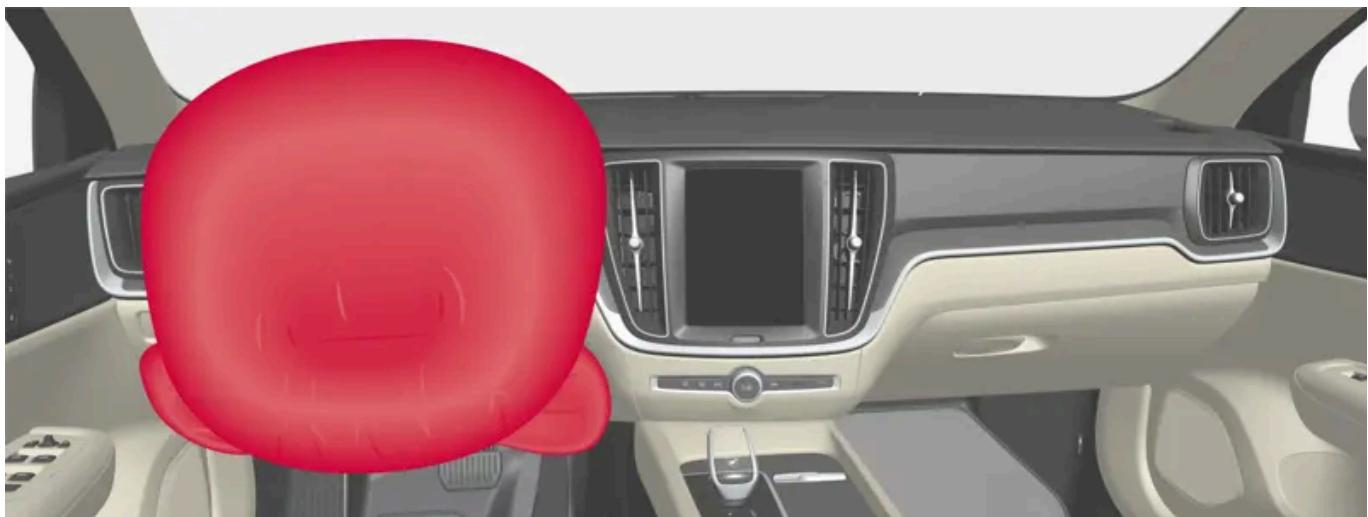
Airbag nel volante e airbag ginocchia<sup>[1]</sup> nel sedile anteriore sul lato conducente.
