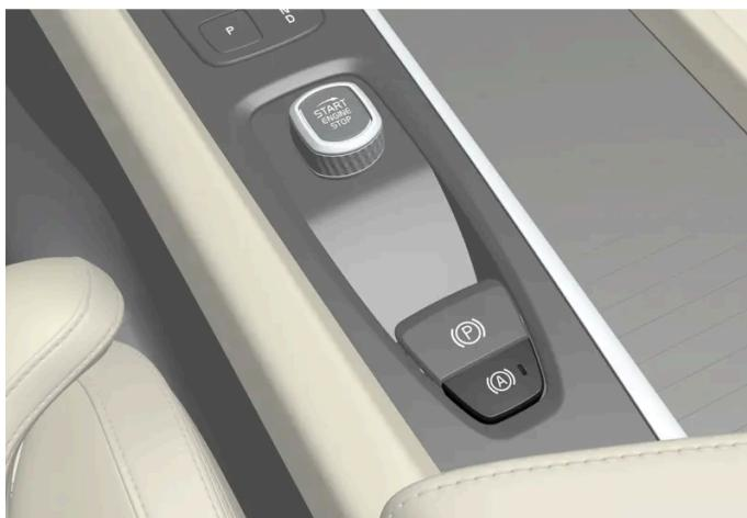
**1** Premere il pulsante nel tunnel per attivare o disattivare la funzione.
