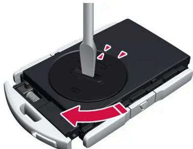
Riposizionare il coperchio della batteria e ruotarlo in senso orario in posizione CLOSE
