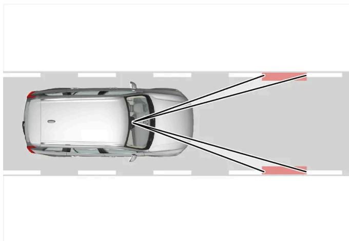
Driver Alert rileva la posizione dell'automobile nella corsia di marcia.
