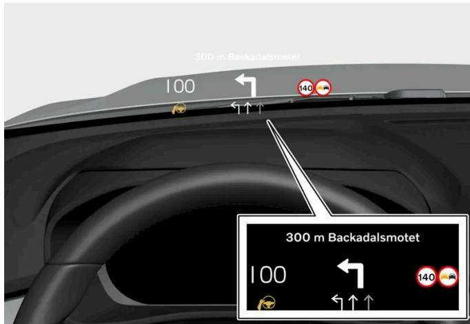
L'Head-Up Display proietta le informazioni del display del conducente sul parabrezza davanti al conducente. Le informazioni possono essere viste solo dalla posizione del conducente.
