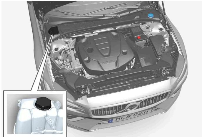
Serbatoio di espansione dell'impianto di raffreddamento
