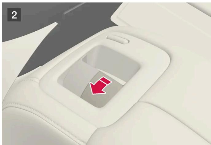
Per le automobili senza ripiegamento elettronico, i poggiatesta esterni si ripiegano manualmente con il comando interno sul lato superiore del sedile, vedere figura 2.
