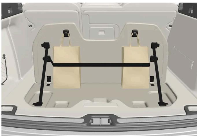
All'interno della copertura, parte integrante della botola del bagagliaio, vi sono due ganci per borse della spesa e una banda elastica [\[1\]](#). La fascia può essere montata in quattro posizioni.
