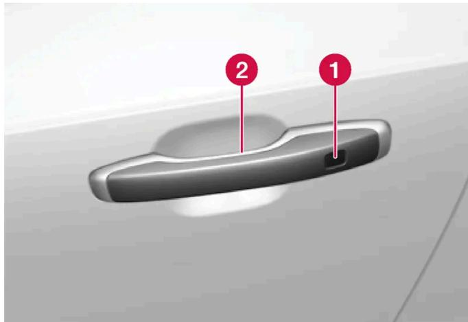
① Rientranza sensibile per il bloccaggio
