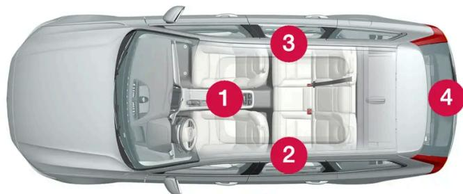
Posizione delle antenne:
