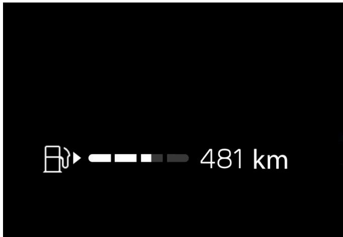
L'area bianca nell'indicatore del carburante mostra la quantità di carburante nel serbatoio.
