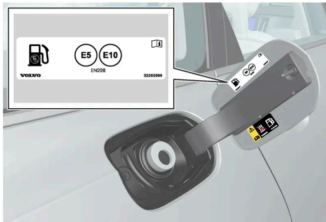
Utilizzare un carburante approvato per l'automobile, vedere l'identificatore [\[1\]](#) all'interno dello sportello del serbatoio. Per informazioni sui carburanti approvati e sull'identificatore, vedere la sezione "Benzina".
