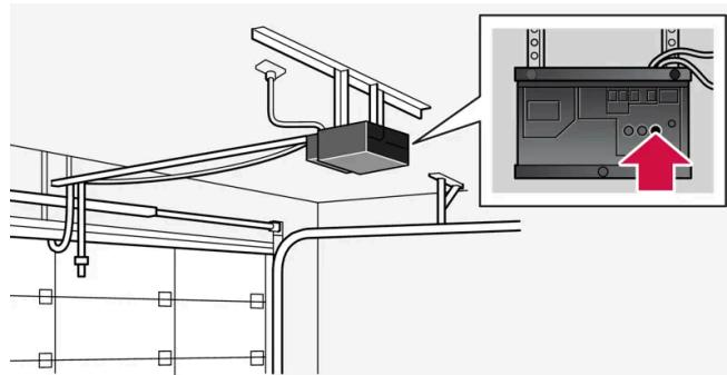
Localizzare il pulsante di apprendimento [2] del ricevitore, ad esempio del portone del garage. Solitamente si trova accanto all'attacco dell'antenna sul ricevitore.
