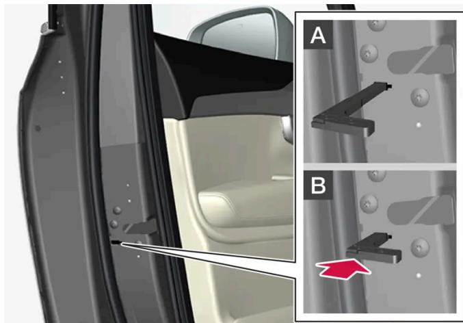
Bloccaggio manuale della portiera. Da non confondere con le serrature per bambini.
