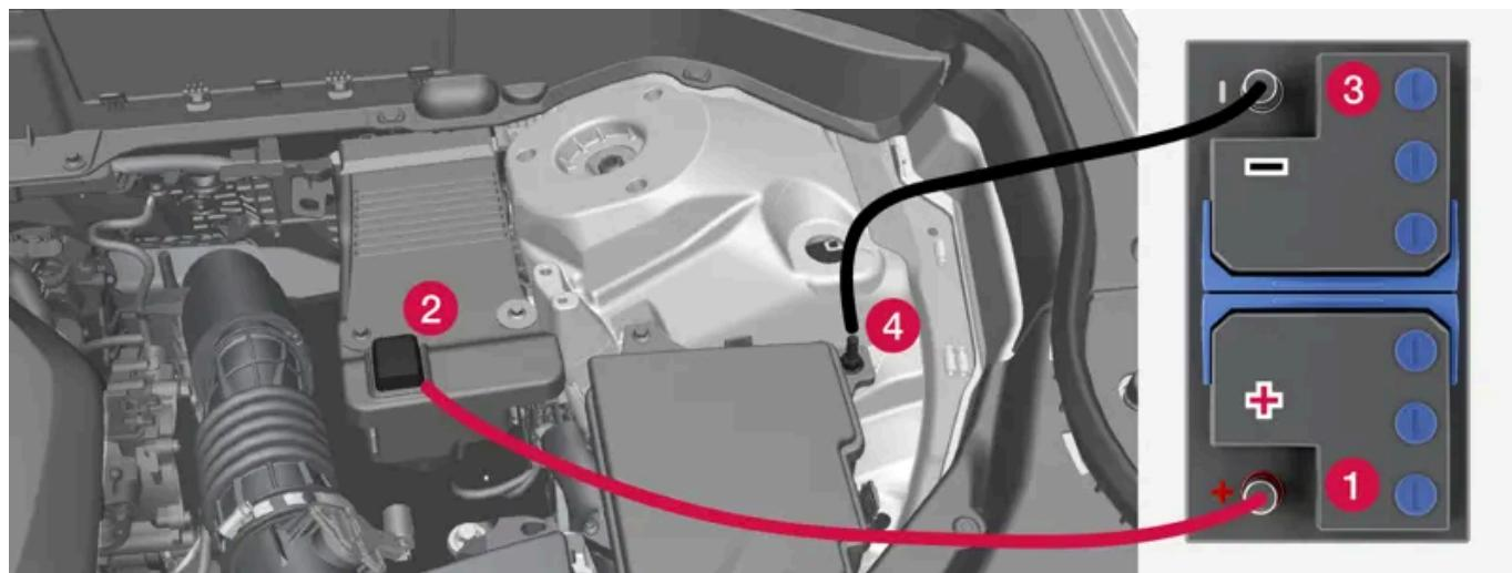
Punti di ricarica per l'avviamento ausiliario della propria automobile. L'aspetto del vano motore può variare a seconda di modello di automobile e livello di equipaggiamento.
