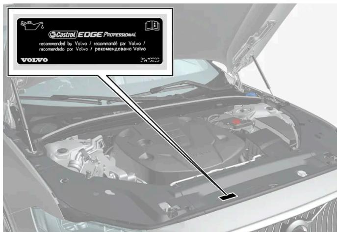
Posizione dell'etichetta di avvertimento per il vano motore. Il vano motore può differire leggermente in base al modello e al tipo di motore.
