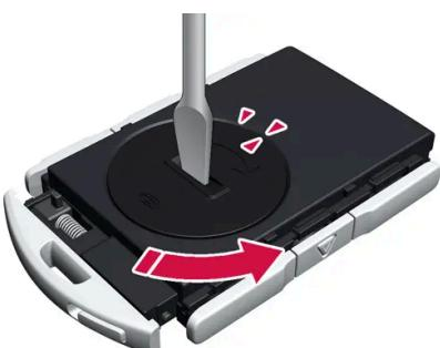
Ruotare il coperchio della batteria in senso antiorario in posizione OPEN Usare ad es. un cacciavite o una moneta.
