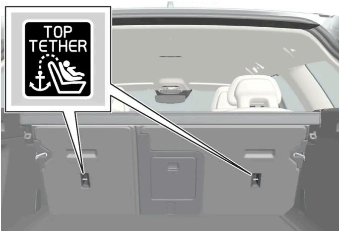
La posizione dei punti di fissaggio per il sedile posteriore è indicata da simboli sul retro dello schienale.
