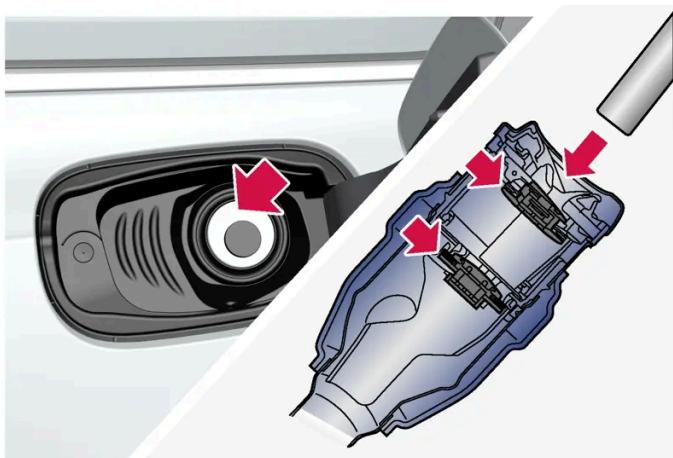
Prima di iniziare il rifornimento, è importante inserire l'ugello della pompa in entrambi gli sportelli apribili del tubo di rifornimento.
