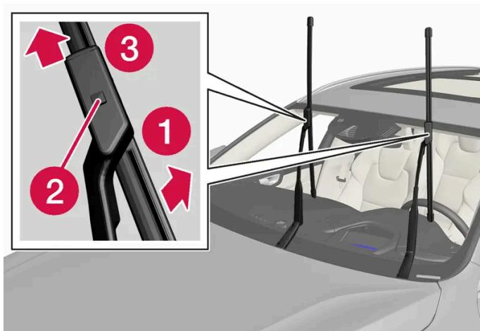
Impostare i tergicristalli in posizione di assistenza e sollevare i bracci dei tergicristalli. La posizione di assistenza si attiva/disattiva dal display centrale ad automobile ferma con i tergicristalli non attivati.
