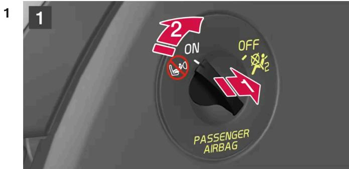
Estrarre il commutatore e ruotarlo da ON a OFF.
