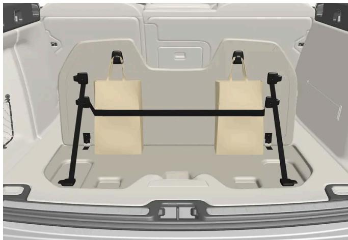
All'interno della copertura, parte integrante della botola del bagagliaio, vi sono due ganci per borse della spesa e una banda elastica<sup>[1]</sup>. La fascia può essere montata in quattro posizioni.
