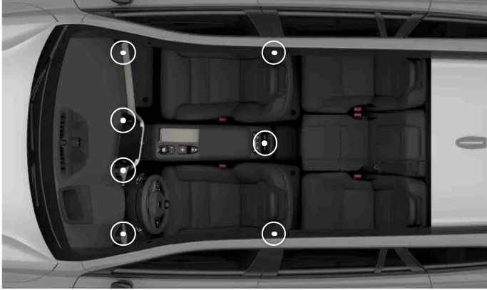
Posizione delle bocchette di ventilazione regolabili
