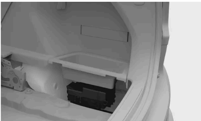
Posizione del portafusibili
