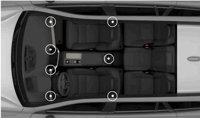
Posizione delle bocchette di ventilazione regolabili
