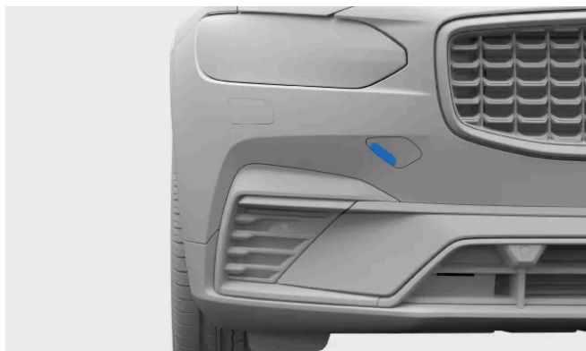
Coperchio di fissaggio dell'occhiello di traino anteriore
