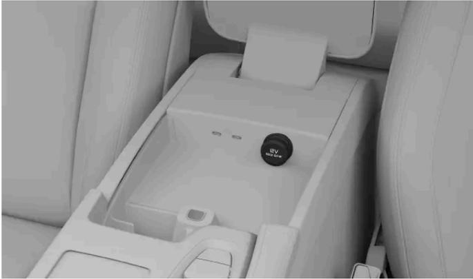
La presa elettrica da 12 V nel tunnel centrale
