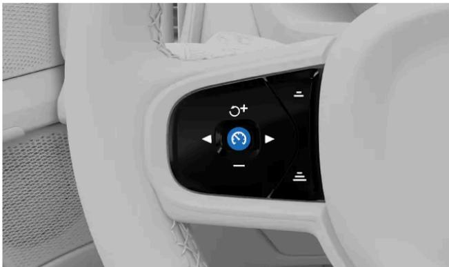
Quando puoi farlo in modo sicuro, premi il pulsante del Pilot Assist
