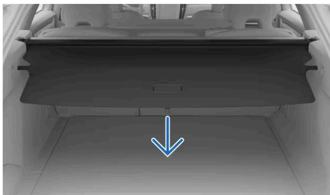
Estrarre la schermata del pianale tramite la maniglia sopra i pannelli laterali del bagagliaio.
