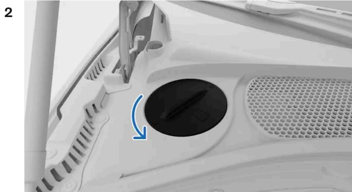
Apri lo sportello del pannello nell'angolo superiore sinistro del vano motore per accedere al contenitore del liquido di raffreddamento.
