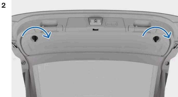
Il triangolo di emergenza si trova all'interno del bagagliaio. Apri il vano ruotando le maniglie in posizione verticale e poi tirale.
