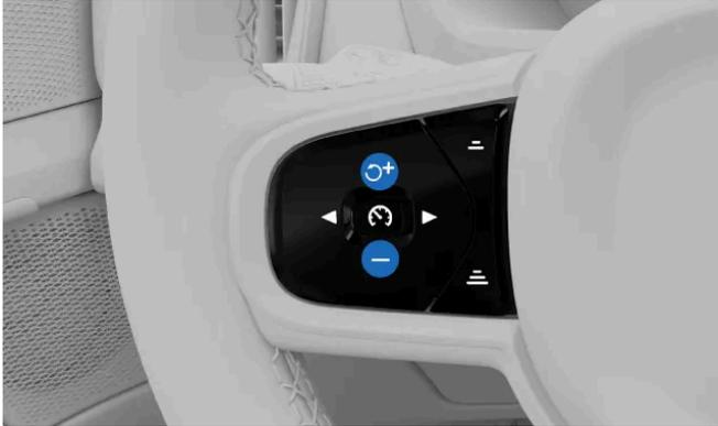
Regola la velocità di riferimento usando i pulsanti sul volante.
