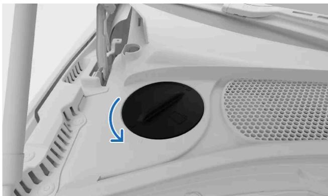
Apri lo sportello del pannello nell'angolo superiore sinistro del vano motore per accedere al contenitore del liquido di raffreddamento.
