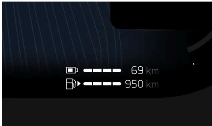
La tua autonomia dipende principalmente dalla batteria della tua auto, dalla quantità di carburante rimasto nel serbatoio della tua auto e dal tuo stile di guida, ma anche le condizioni esterne possono influire. Il livello della batteria e l'autonomia prevista sono visualizzati nel display del conducente. L'autonomia prevista viene calcolata in base al tuo stile di guida, attuale e storico.
