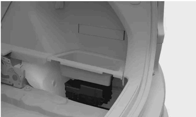
Posizione del portafusibili
