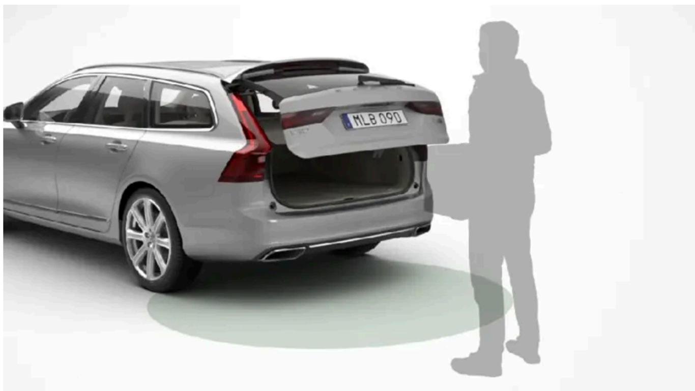
Se l'automobile è dotata di bloccaggio e sbloccaggio senza chiave\*, è possibile sbloccare il portellone con il movimento del piede.
