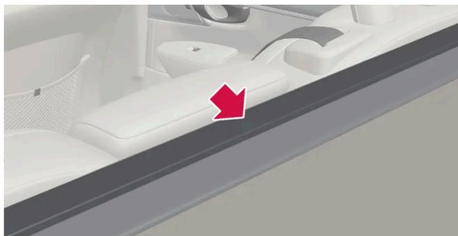
Ripiegare in avanti la piastra protettiva anteriore del copribagagliaio per eliminare lo spazio fra copribagagliaio e schienale posteriore.
