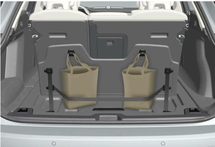
All'interno della copertura, parte integrante della botola del bagagliaio, vi sono due ganci per borse della spesa e una banda elastica<sup>[1]</sup>. La fascia può essere montata in quattro posizioni.
