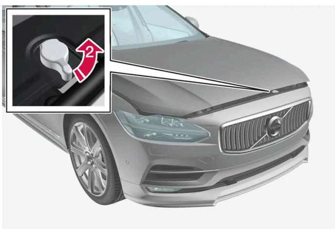
➡ Ruotare la maniglia sotto il cofano in senso antiorario per disimpegnare il cofano dal fermo della serratura del cofano e sollevare il cofano.
