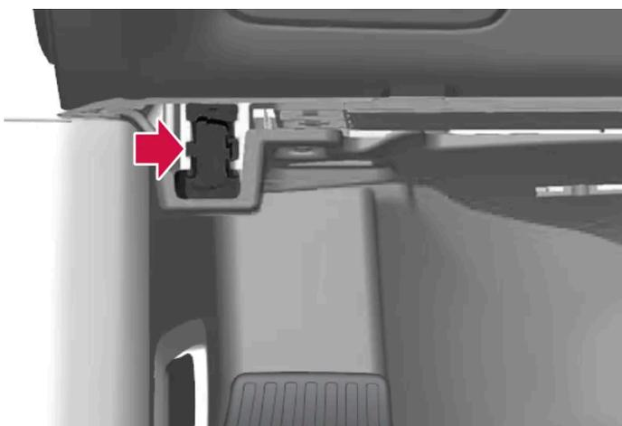
La presa diagnostica (presa On-board Diagnostic, OBDII) sotto il cruscotto sul lato conducente.
