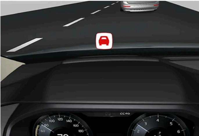
Il simbolo di allarme del City Safety lampeggia per attirare l'attenzione del conducente se sussiste il rischio di collisione.
