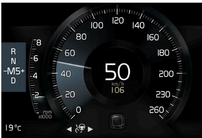
Indicatore cambio di marcia sul display del conducente da 8" per la leva selettore piccola.
