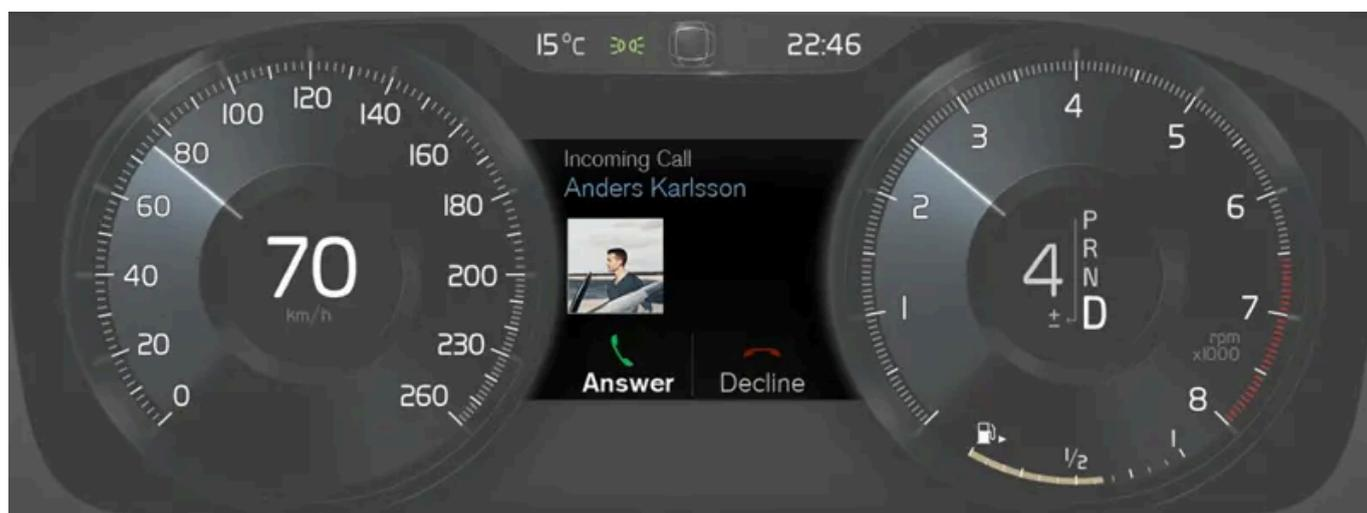
Esempio di messaggio sul display del conducente. La figura è schematica - i dettagli possono differire a seconda del modello di automobile.
