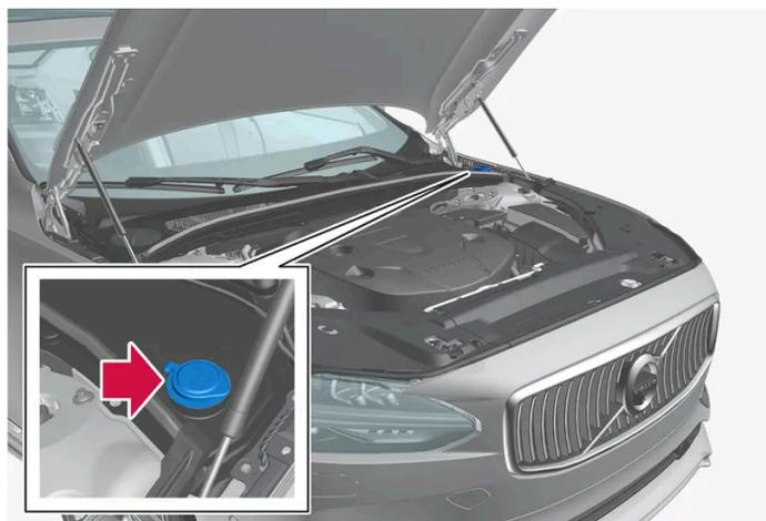
Il liquido lavacrystalli si rabbocca nel serbatoio con il tappo blu. Il serbatoio è usato per il lavap parabrezza, il lavalunotto e il lavafari\*.
