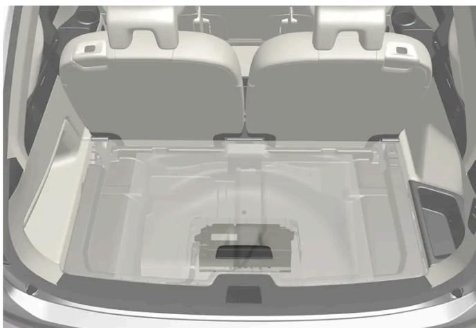
Le auto del tipo Mild Hybrid sono dotate invece di una batteria ausiliaria 48 V ubicata sotto il vano di carico. La scatola sopra la batteria ausiliaria da 48 V può essere manipolata solo da riparatori autorizzati.
