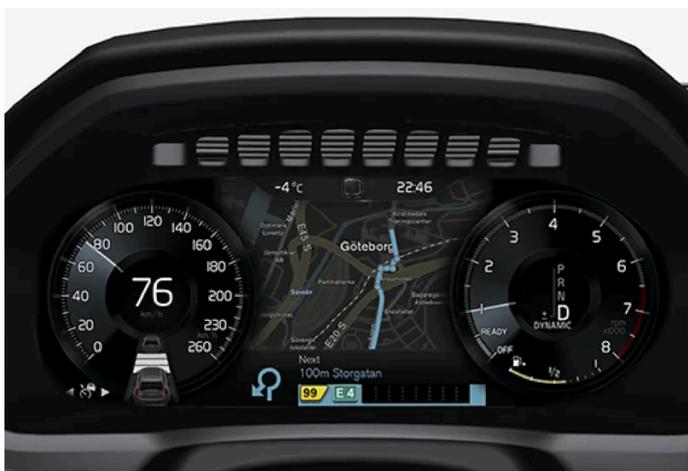
La mappa è visualizzata solamente sul display del conducente da 12".
