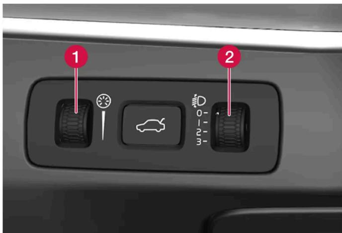
Le automobili con fari a LED<sup>[3]</sup> \* sono dotate di comando incidenza fari automatico, quindi sono sprovviste della rotella per la regolazione dell'incidenza fari.
