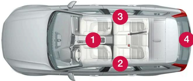
Posizione delle antenne:
