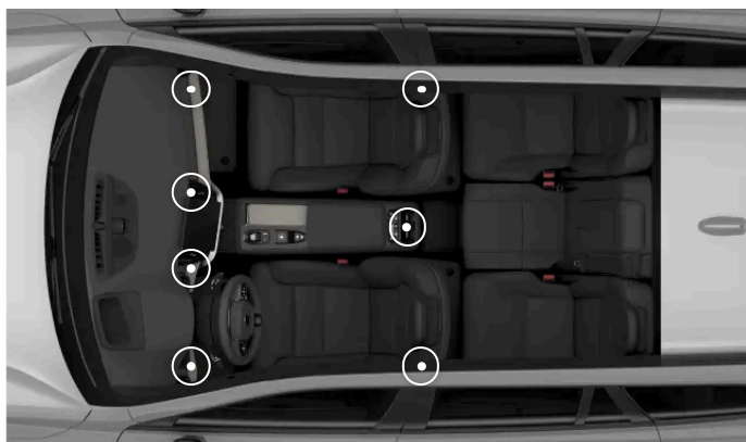
Posizione delle bocchette di ventilazione regolabili
