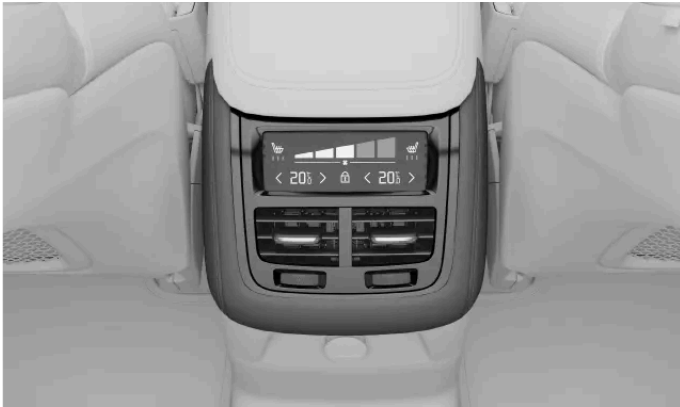
Comandi del climatizzatore nel tunnel centrale
