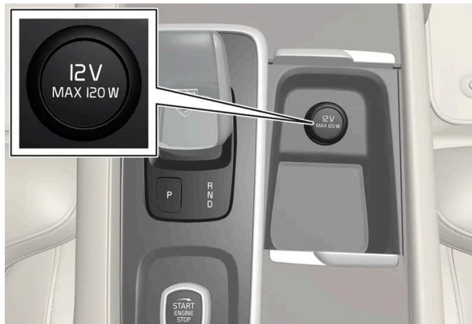
Presa elettrica anteriore nel tunnel per le automobili senza caricabatteria wireless per telefono*.
