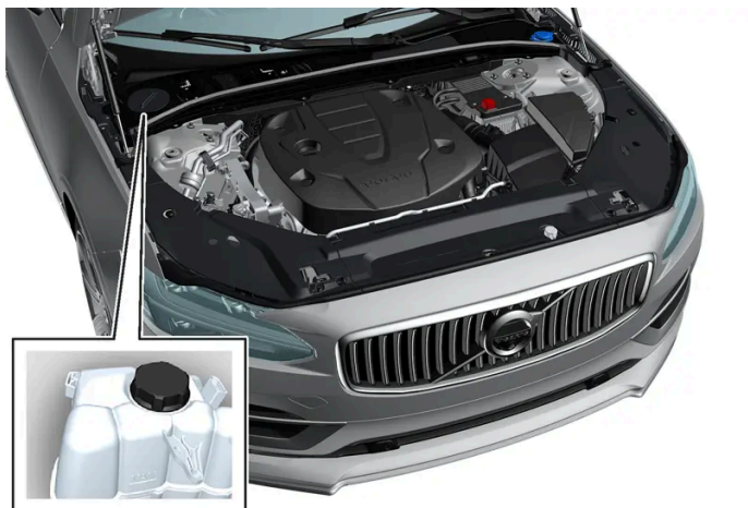
Serbatoio di espansione dell'impianto di raffreddamento, automobile con guida a sinistra.
