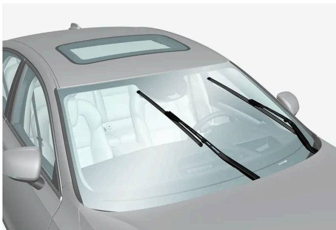
Spazzole tergicristallo in posizione di assistenza.
