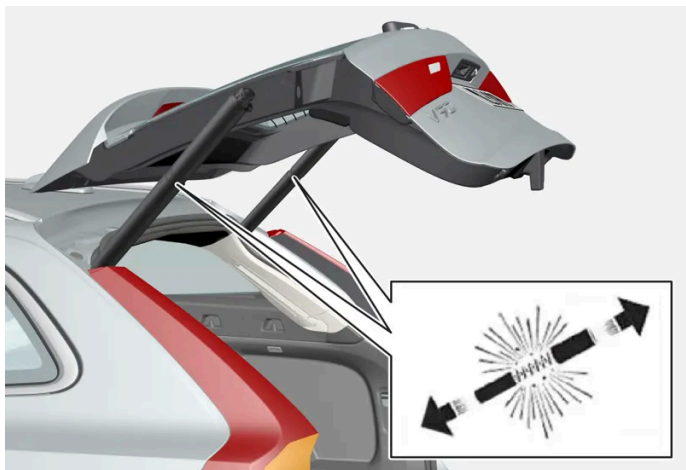
Le molle precaricate del portellone elettrocomandato.
