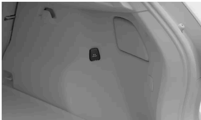
La presa elettrica da 12 V sul lato destro del bagagliaio
