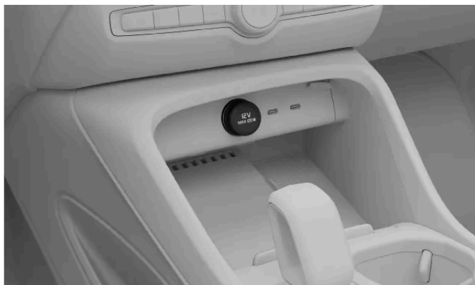
La presa elettrica da 12 V nel tunnel centrale
