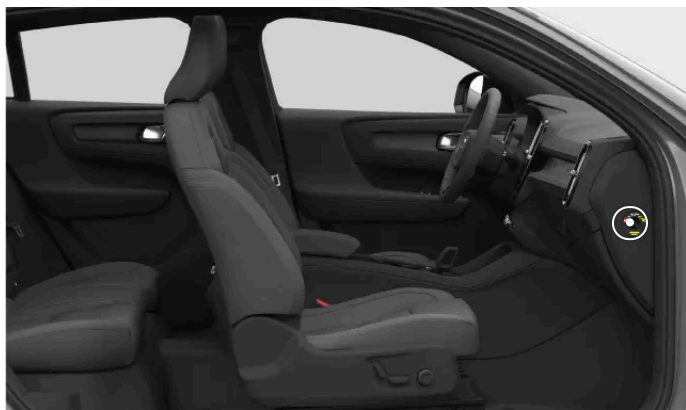
Posizione dell'interruttore dell'airbag passeggero
