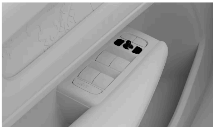
Comandi per la regolazione degli specchietti laterali
