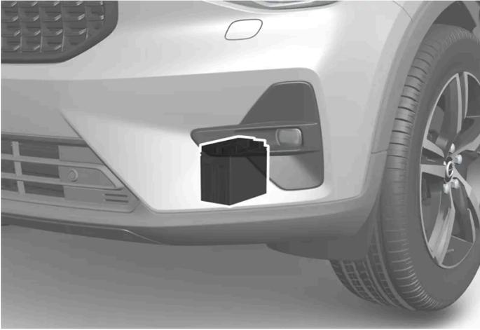
La batteria ausiliaria è ubicata nella parte bassa del vano motore.
