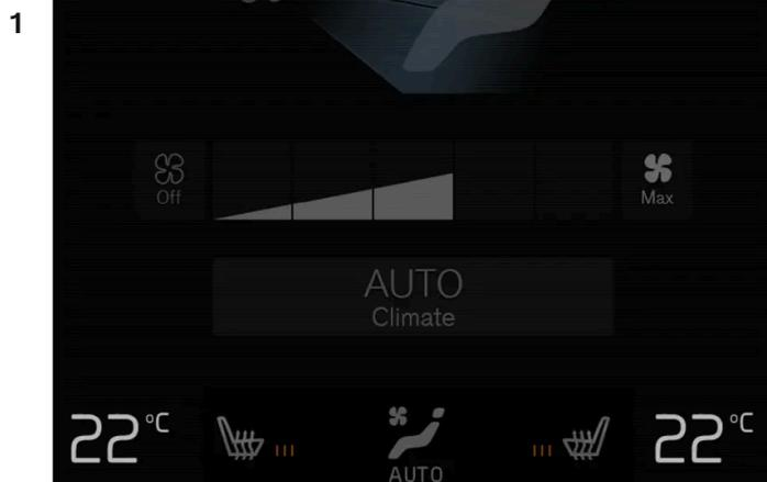
Pulsanti di temperatura nella barra del climatizzatore.<sup>[2]</sup>
