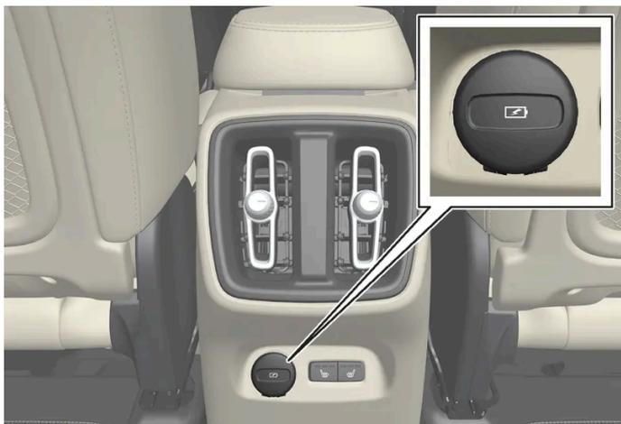
Porte USB\* (tipo C) sul retro del tunnel per la ricarica, ad esempio, di telefoni e tablet<sup>[1]</sup>.
