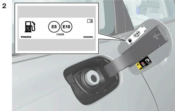
Utilizzare un carburante approvato per l'automobile, vedere l'identificatore<sup>[1]</sup> all'interno dello sportello del serbatoio. Per informazioni su carburanti approvati e identificatore, vedere la sezione "Benzina".
