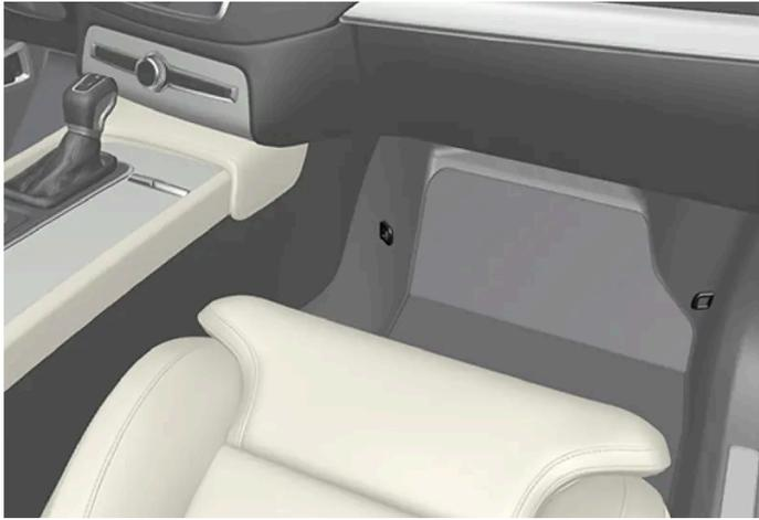
Posizione dei punti di fissaggio nel sedile anteriore.
