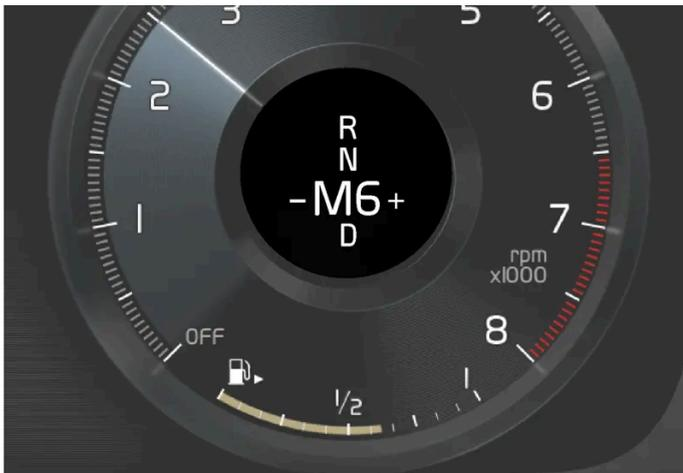
Panoramica della posizione di cambio manuale sul display del conducente.
