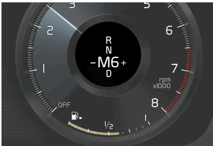
L'indicatore cambio di marcia segnala la marcia inserita sul display del conducente e invita a passare alla marcia superiore visualizzando un segno + lampeggiante.
