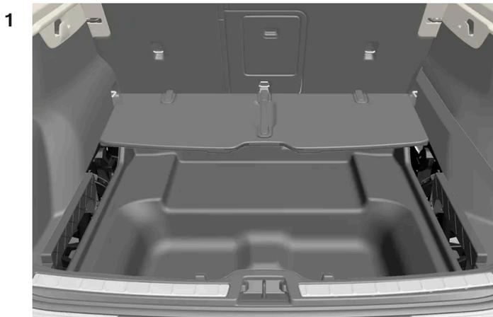
Ritirare il pavimento del bagagliaio pieghevole in avanti per sistemare il piano portaoggetti con il lato superiore verso il basso e la parte posteriore rivolta in avanti.
