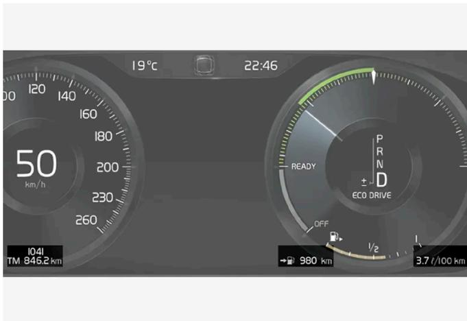
Esempio di informazioni del computer di bordo sul display del conducente. La figura è schematica - i dettagli possono differire a seconda del modello di automobile.
