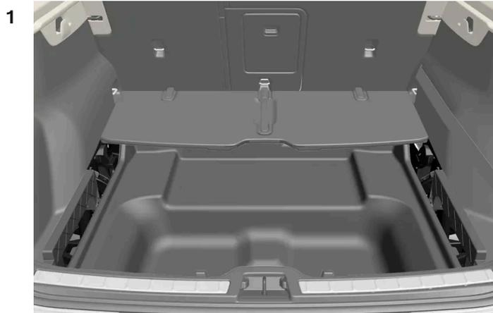
Ripiegare il pavimento del bagagliaio pieghevole in avanti.
