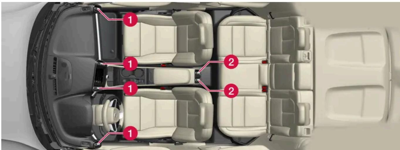
Posizione delle bocchette di ventilazione regolabili nell'abitacolo.
