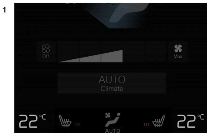
Pulsanti di temperatura nella barra del climatizzatore.<sup>[2]</sup>
