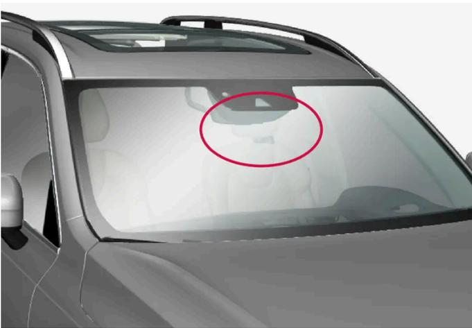
Posizione dell'unità telecamera e radar anteriore
