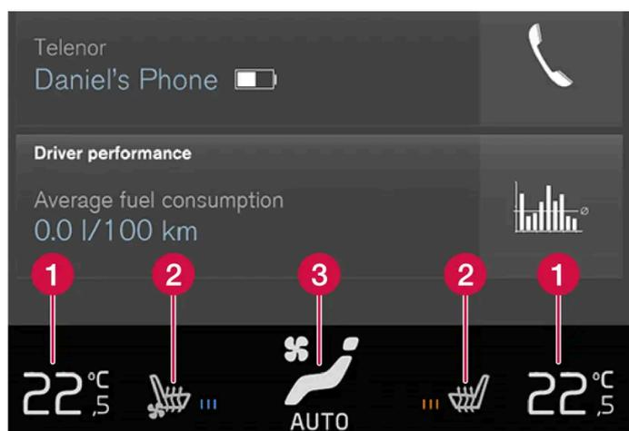
Barra del climatizzatore con climatizzatore a 2 zone. La barra del climatizzatore con climatizzatore a 1 zona presenta alcune differenze per quanto riguarda la posizione dei comandi.
