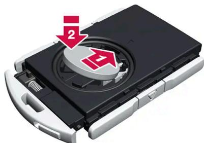
Inserire una nuova batteria con il lato + verso l'alto. Non toccare con le dita i contatti della batteria della chiave.
