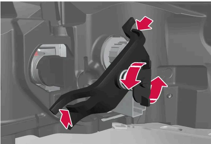
3. Svitare la vite in senso antiorario, premere i fermagli sui lati e rimuovere il ponticello di supporto. Si consiglia di lasciare la vite nel ponticello di supporto.
