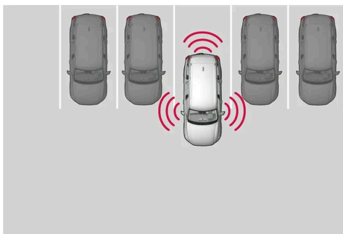
Principio per il posizionamento durante un parcheggio in perpendicolare.
