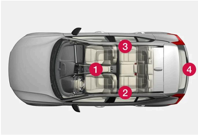
Posizione delle antenne:
