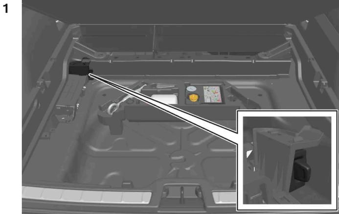
Inserire una SIM card personale nel supporto sotto il pavimento del bagagliaio.
