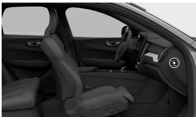
Posizione dell'interruttore dell'airbag passeggero
