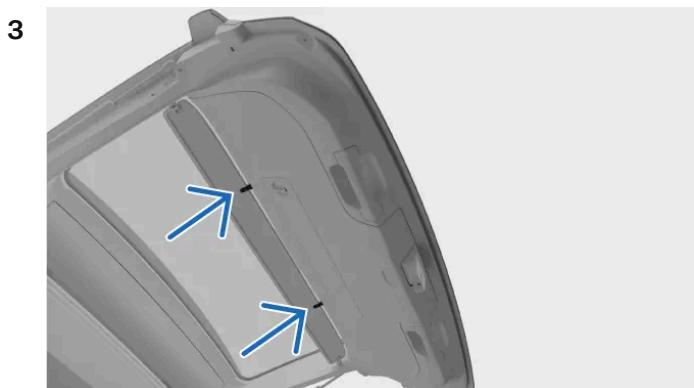
Spingi verso l'alto le due clip sul lato lungo della copertura del bagagliaio e falle scattare in posizione sul bagagliaio.
