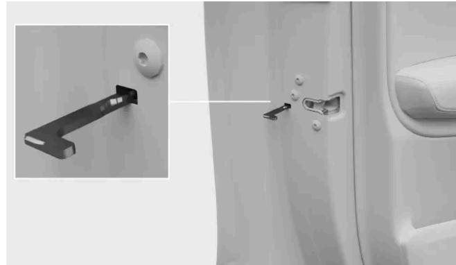
Ubicazione del dispositivo di bloccaggio
