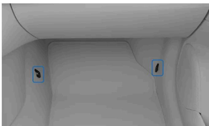
I punti di fissaggio della cinghia inferiore del sedile del passeggero anteriore si trovano ai lati del vano piedi del sedile.
