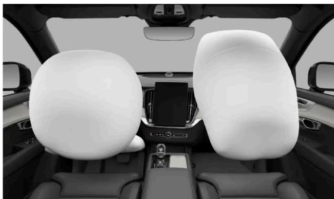
Nel lato di guida ci sono due airbag anteriori. L'airbag superiore è incorporato dentro il volante, mentre l'airbag per le ginocchia si trova dietro un pannello sotto il volante.
