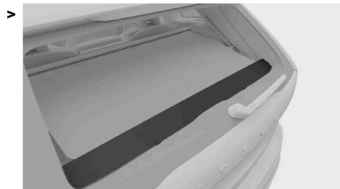
La copertura del bagagliaio è installata e copre il vano di carico del bagagliaio.
