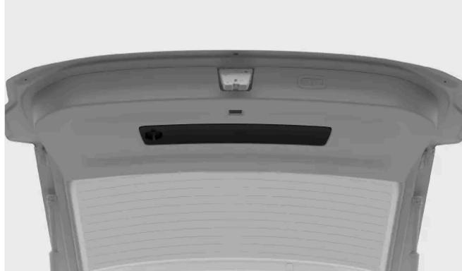
Il triangolo di emergenza si trova all'interno del bagagliaio. Apri il vano ruotando la maniglia in posizione verticale e poi tirala.
